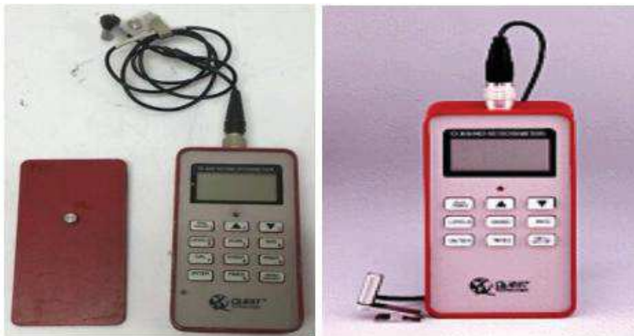
Figura V.1.6.1-1 - Imagem ilustrativa dos equipamentos: Dosímetro Quest Q-400 e (esquerda) e Dosímetro Quest QC-10 (direita).
