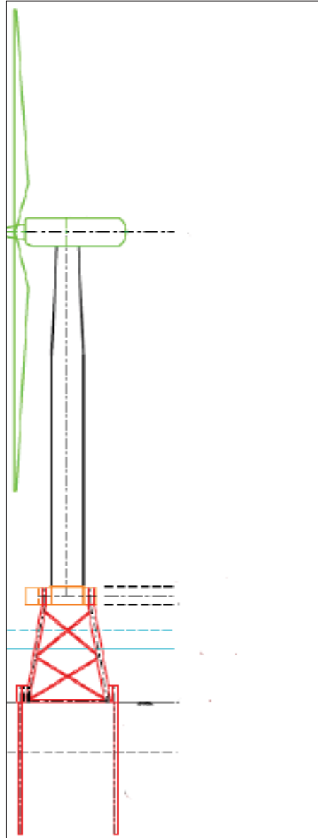
Figura III.1.1-2- Esquema do aerogerador e sua subestrutura
