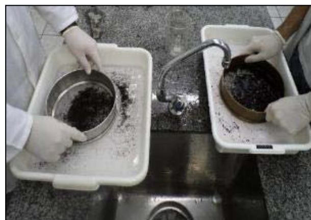
Foto 6.2.3.1-26: Lavagem da amostra em peneiras de malhas de 1000 \mu m e 500 \mu m
