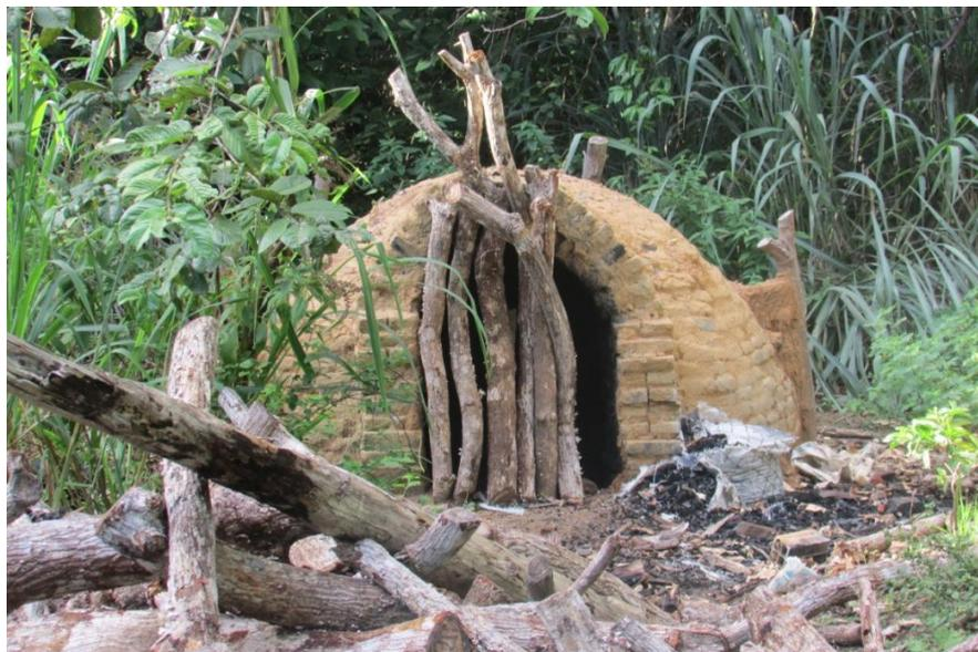
**Foto 1.7.3-8** - Forno utilizado na produção de carvão vegetal a partir da madeira proveniente do facho.
