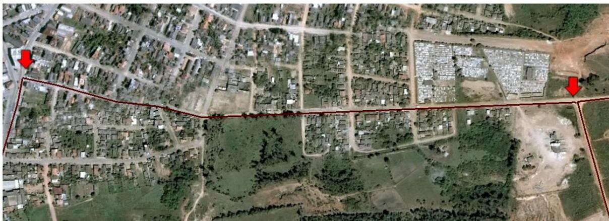
**Figura 07.** Segmento inserido em área preponderantemente residencial, com pavimento de paralelepípedos regulares e irregulares (potencialmente deformáveis com o trânsito de veículos pesado), bem como trechos de pavimento de saibro,
