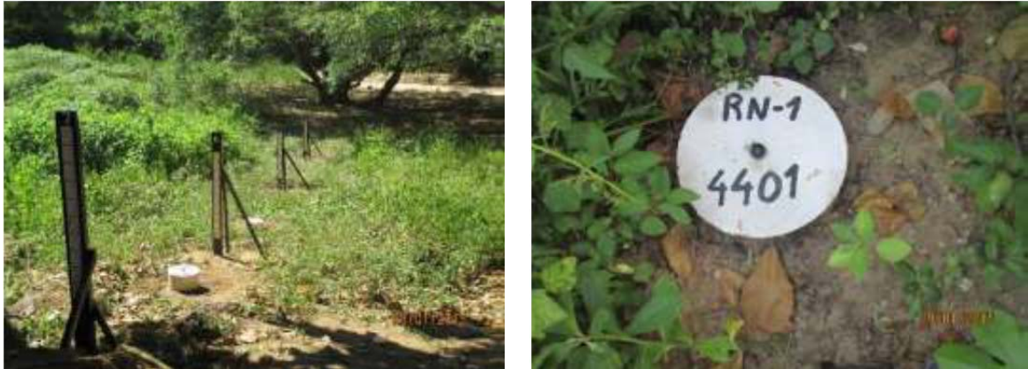
Figura 6 – Seção de Réguas e Referência de Nível da estação fluviométrica UHE Santa Clara Francisco Sá
