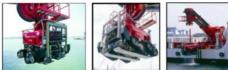
Figura III-9 - ROV T200 utilizado na instalação de cabos submarinos .
