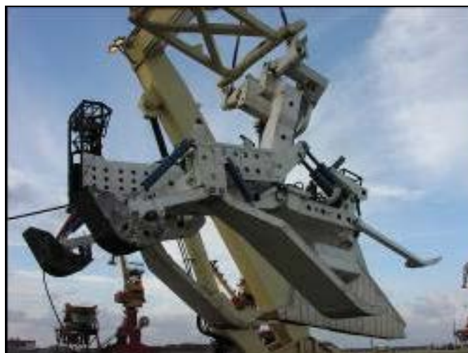
Figura III-8 - Arado Marinho do tipo SMD.
