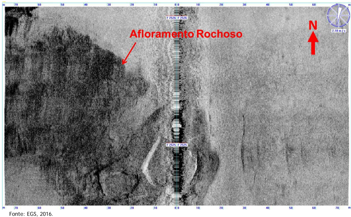
Figura V.1.3-20 - Exemplo de imagem do levantamento sonográfico próximo à posição KP2.4 mostrando afloramento rochoso.
