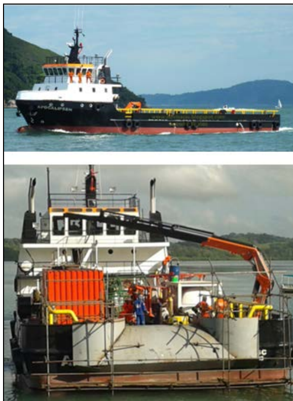
Figura III-6 - Apocalipse-H -embarcação a ser utilizada na instalação do cabo submarino em zonas rasas (do limite da praia até lâmina d'água 15 m).
