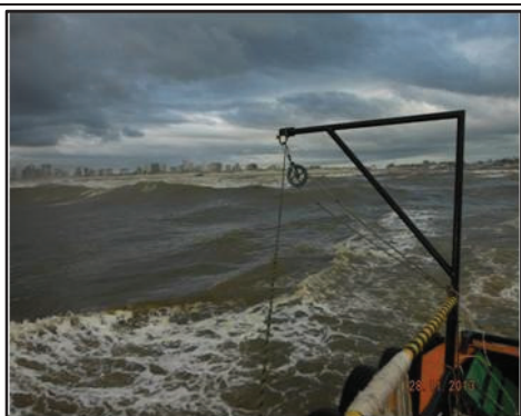
Figura III-1 - Guincho com roldana confeccionado e instalado na embarcação.
