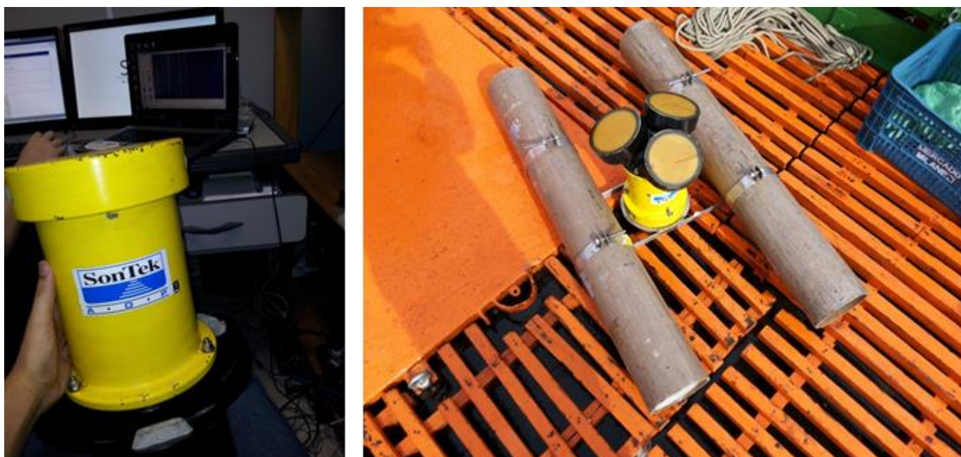
Figura 4. Equipamento ADCP e estrutura de flutuação tipo catamarã, utilizados na aquisição dos dados correntográficos.
