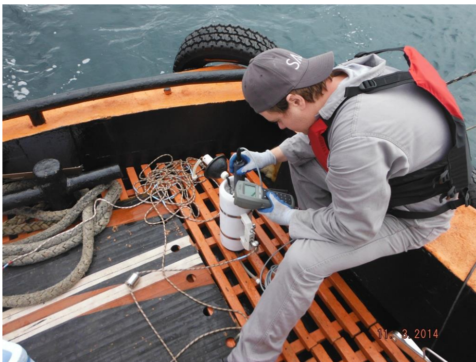
Figura 3. Procedimento de medição dos parâmetros físico-químicos da água do mar realizado em campo, utilizando a sonda multiparâmetros Hanna HI-9828 e a garrafa de coleta do tipo Van Dorn.
