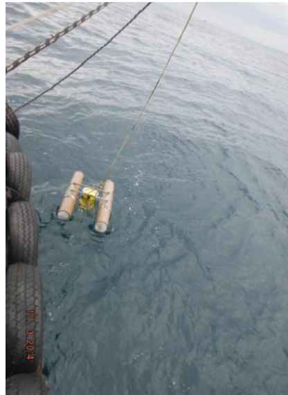
Figura III-4 - Coleta de dados de correntometria, utilizando Acoustic Doppler Profiler (ADP).
