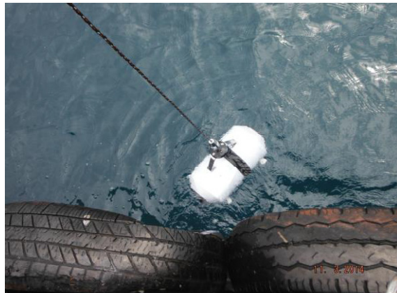
Figura III-2 - Coleta de água superficial e de fundo utilizando garrafas de van Dorn, confeccionadas em nylon.
