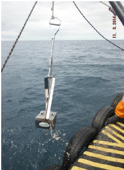
Figura III-3 - Draga de inox utilizada para coleta de sedimento.
