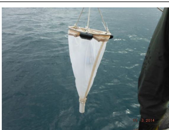
Figura III-5 - Arrasto vertical de Fitoplâncton, com fluxômetro fixado na boca da rede.
