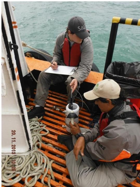
Figura 3. Procedimento de medição dos parâmetros físico-químicos da água do mar realizado em campo, utilizando a sonda multiparâmetros Hanna HI-9828 e a garrafa de coleta do tipo Van Dorn.
