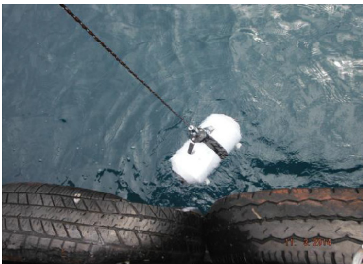
Figura 03 – Lançamento da garrafa de van Dorn para a coleta de água.
