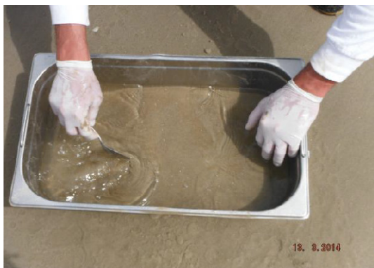
Figura 13 – Homogeneização das amostras de sedimento utilizando espátulas em aço inox.
