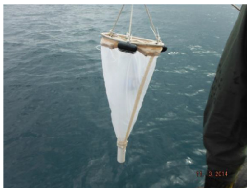
Figura 16 – Lançamento da rede para a coleta da comunidade planctônica.
