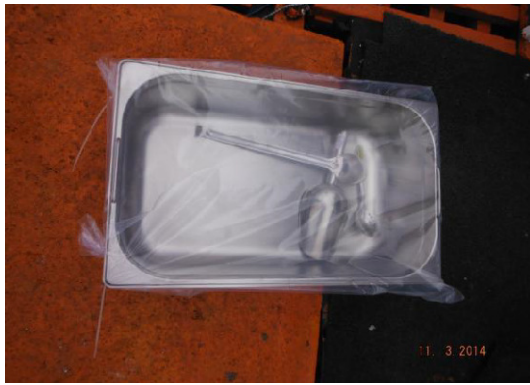
Figura 07 – Bandejas e espátulas, em aço inox, utilizadas para homogeneizar o sedimento coletado.
