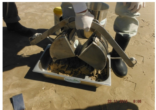
Figura 12 – Retirada das amostras de sedimento praial do pegador do tipo Petersen.
