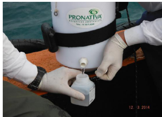
Figura 04 – Armazenamento das amostras em frascaria previamente identificada, fornecida pelo laboratório.
