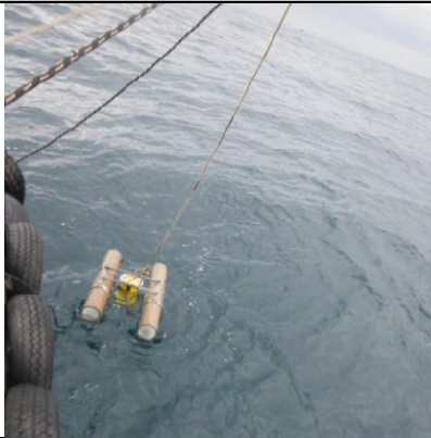
Figura 09 – Lançamento do ADCP para a medição do perfil vertical de correntes.
