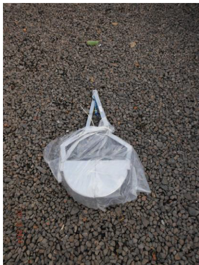
Figura 05 – Pegador do tipo Petersen, em aço inox 316, utilizado para a coleta de sedimento.
