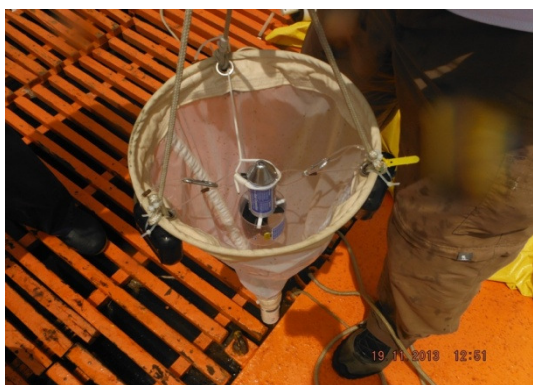
Figura 15 – Rede utilizada para a coleta da comunidade planctônica, incluindo fluxômetro.
