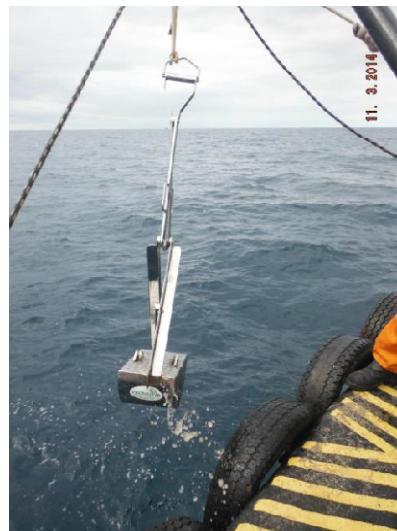
Figura 06 – Retirada do pegador do tipo Petersen contendo o sedimento coletado.
