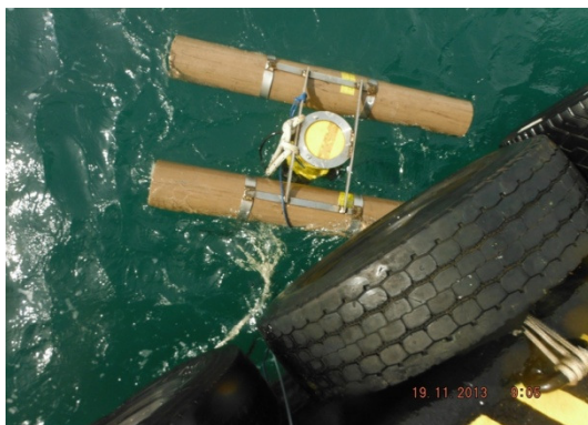
Figura 09 – Lançamento do ADCP para a medição do perfil vertical de correntes.
