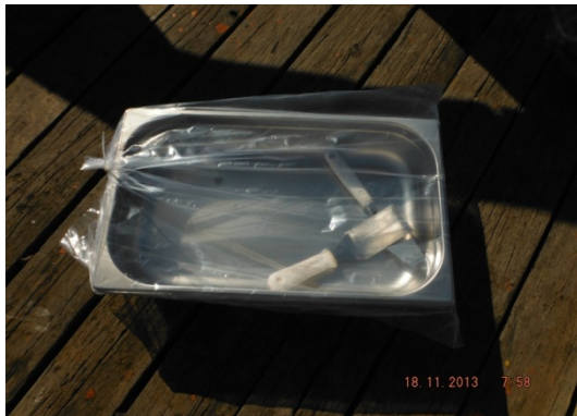
Figura 07 – Bandejas e espátulas, em aço inox, utilizadas para homogeneizar o sedimento coletado.
