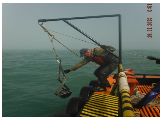
Figura 06 – Retirada do pegador do tipo Petersen contendo o sedimento coletado.
