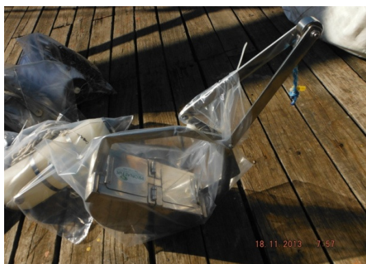
Figura 05 – Pegador do tipo Petersen, em aço inox 316, utilizado para a coleta de sedimento.
