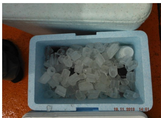
Figura 04 – Acondicionamento das amostras sob refrigeração imediatamente após a coleta.
