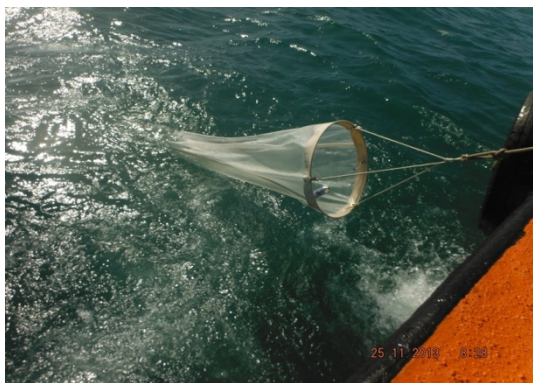
Figura 17 – Retirada da rede de coleta da comunidade planctônica.
