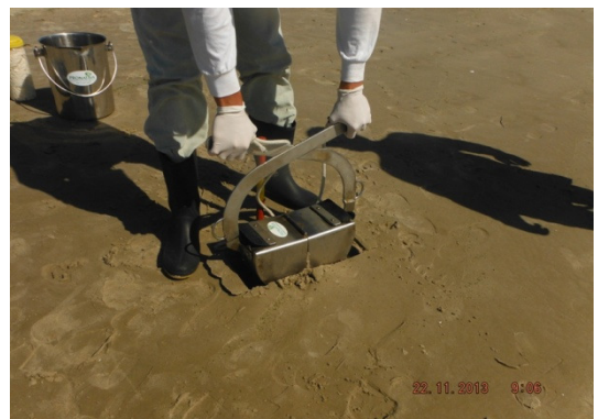
Figura 12 – Coleta da amostra de sedimento praial com pegador do tipo Petersen, em aço inox 316.
