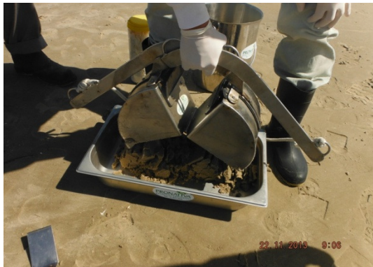
Figura 13 – Retirada das amostras de sedimento praial do pegador do tipo Petersen.
