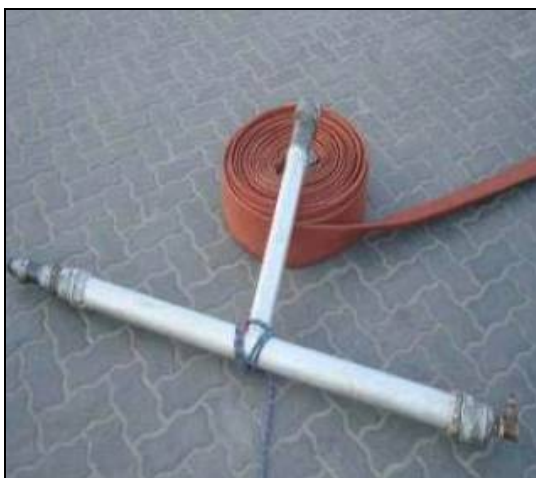
Figura III-10 - Ferramenta de jateamento manual.
