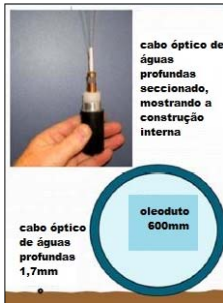
Figura III-2 - Desenho esquemático comparando as dimensões de cabo de fibras ópticas e outra estrutura submarina (oleoduto).
