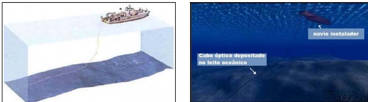
Figura III-5 - Esquema mostrando o lançamento do cabo submarino no leito oceânico.
