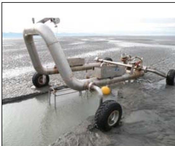
Figura III-12 - Carrinho de jateamento ( jetting sledge )
