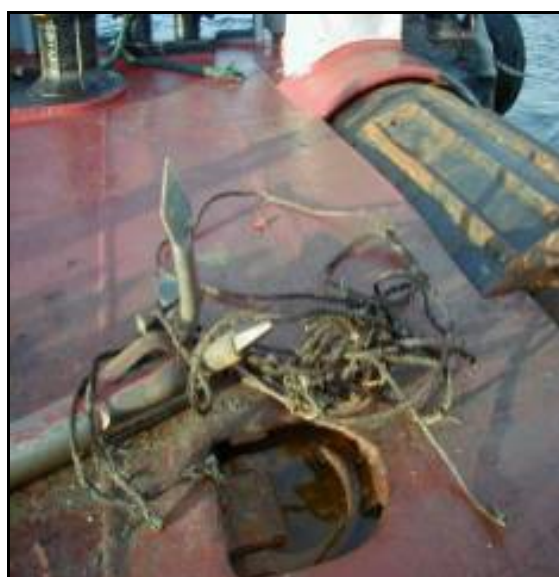
Figura III-17 - Fateixa típica utilizada na remoção de detritos do leito oceânico antes da operação de enterramento do cabo submarino.
