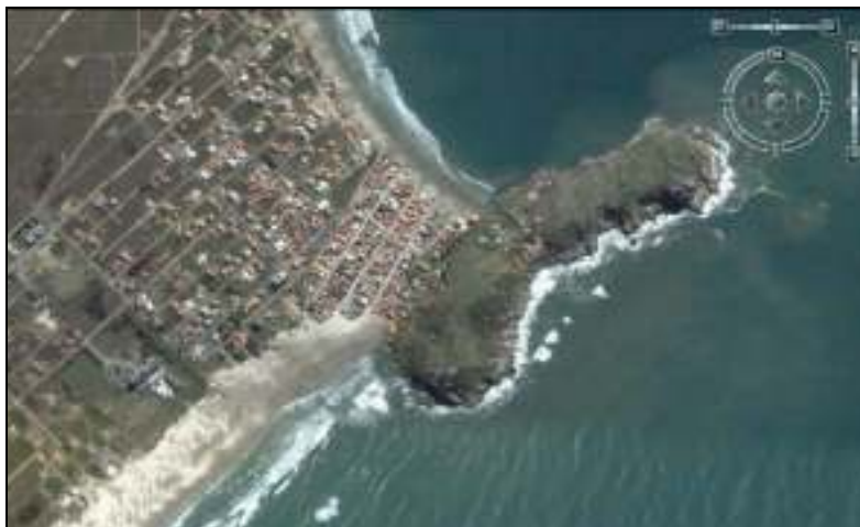
Figura 75. Praia de Itapirubá (SC), costão rochoso interrompendo o transporte de sedimentos de sul para o norte. A larga faixa de areia ao sul e, em contrapartida, a estreita praia ao norte do costão, servem como indicadores geomorfológicos de deriva costeira. Fonte: Zasso et al. (2007).
