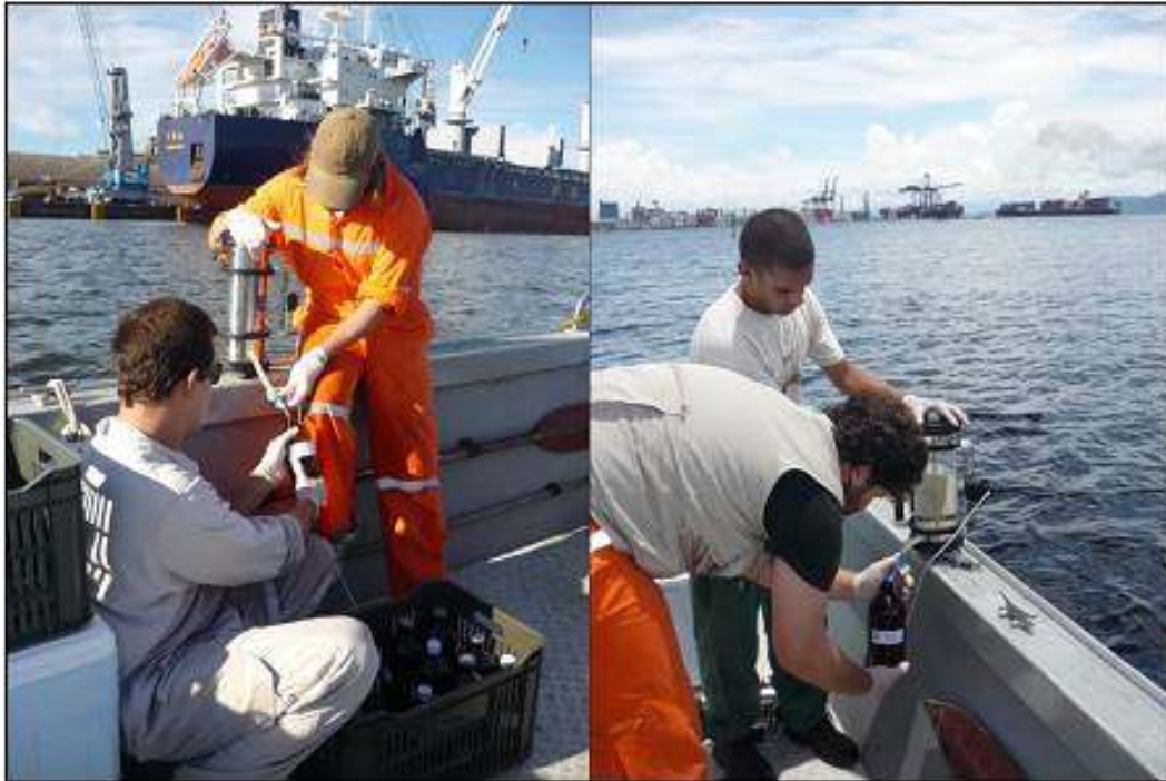
Figura 132. Coleta das amostras de água com a utilização das garrafas tipo van Dorn .
