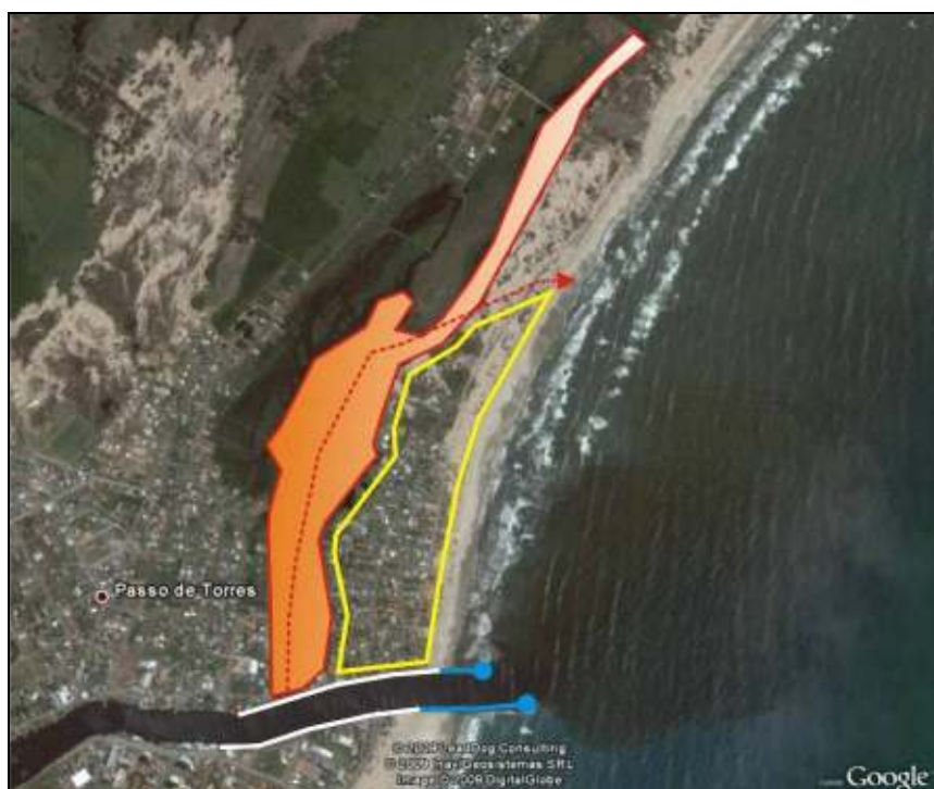
Figura 79. Imagem aérea da desembocadura do rio Mampituba, destacando: o Braço Morto do rio, pintado em laranja; o antigo curso do rio, linha tracejada em vermelho; a planície arenosa que antigamente pertencia ao Rio Grande do Sul e que após as obras passou a ser de Santa Catarina, demarcada em amarelo; as Guias de Corrente, em branco; e os molhes, em azul.
