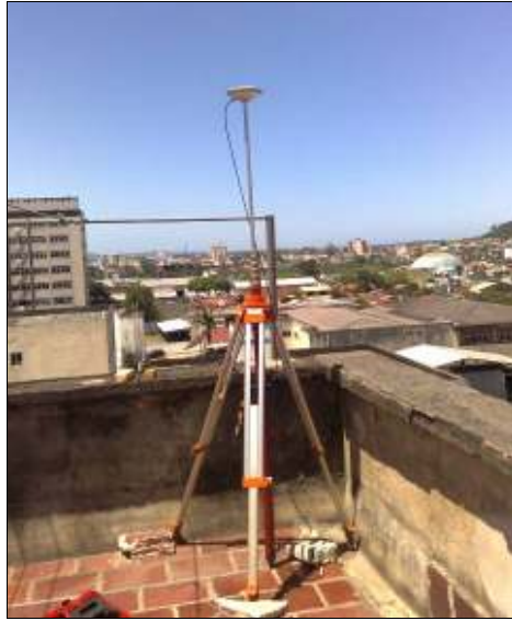
Figura 164. GPS no ponto de referência transportado do SGB.
