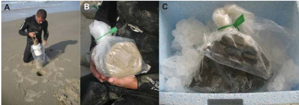
Figura 127. Amostras tipo tubo PVC utilizado para a coleta de sedimento na área da Barra Nova (A). Amostra de sedimento acondicionada em embalagem plástica (B). Amostra refrigerada com gelo em caixa térmica (C).
