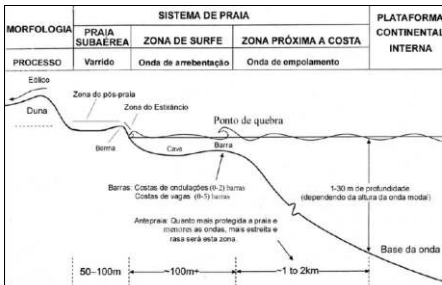
Figura 52. Zonação hidrodinâmica e morfológica tipicamente observada em uma praia arenosa oceânica, modificada por Short (1999).
