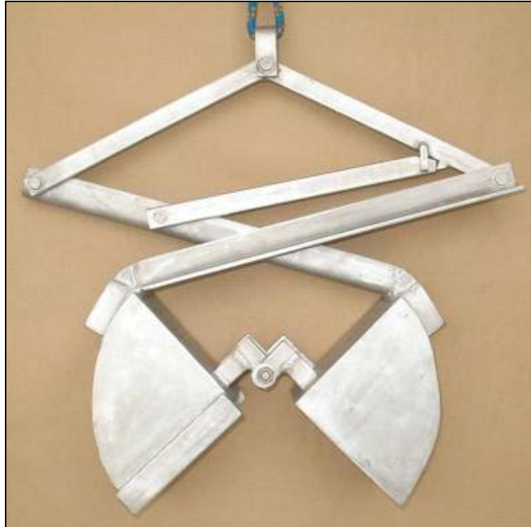
Figura 126. Amostrador tipo van Veen utilizado para a coleta de amostras de sedimento.
