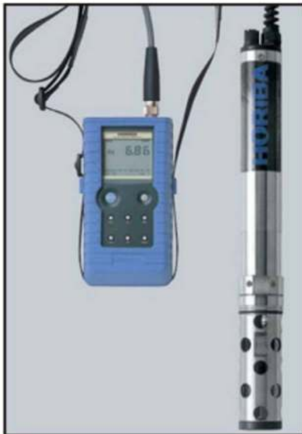
Figura 134. Sonda multiparâmetro utilizada na mensuração de parâmetros in situ .
