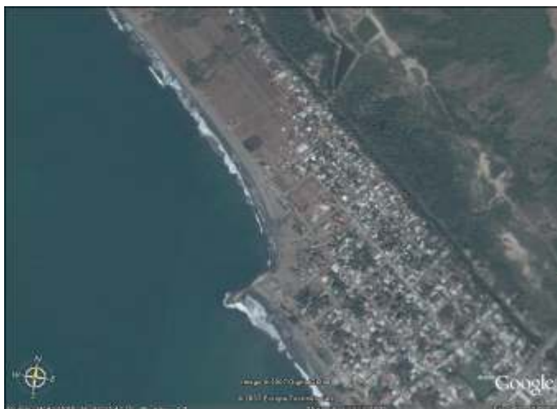
Figura 76. Imagem da erosão praias causada por construção na costa oeste do México. A erosão ao norte da estrutura evidencia que neste caso a deriva costeira resultante é de sul para norte. Fonte: Zasso et al. (2007).
