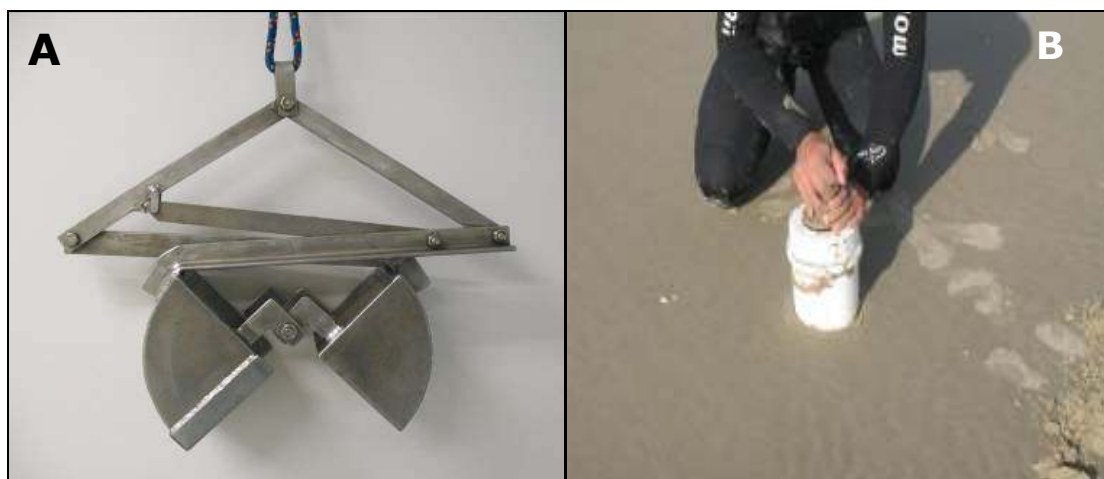
Figura 230. Amostradores para a coleta de macrofauna bêntica: (A) draga busca fundo do tipo van Veen utilizado no rio e área marinha e (B) amostrador de PVC (15 x 15 cm) utilizado na praia arenosa.
