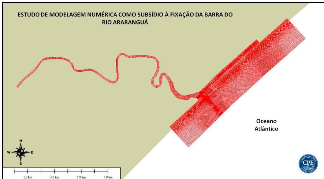
Figura 15: Grade numérica utilizada para a simulação hidrodinâmica, transporte de sedimentos e morfologia.
