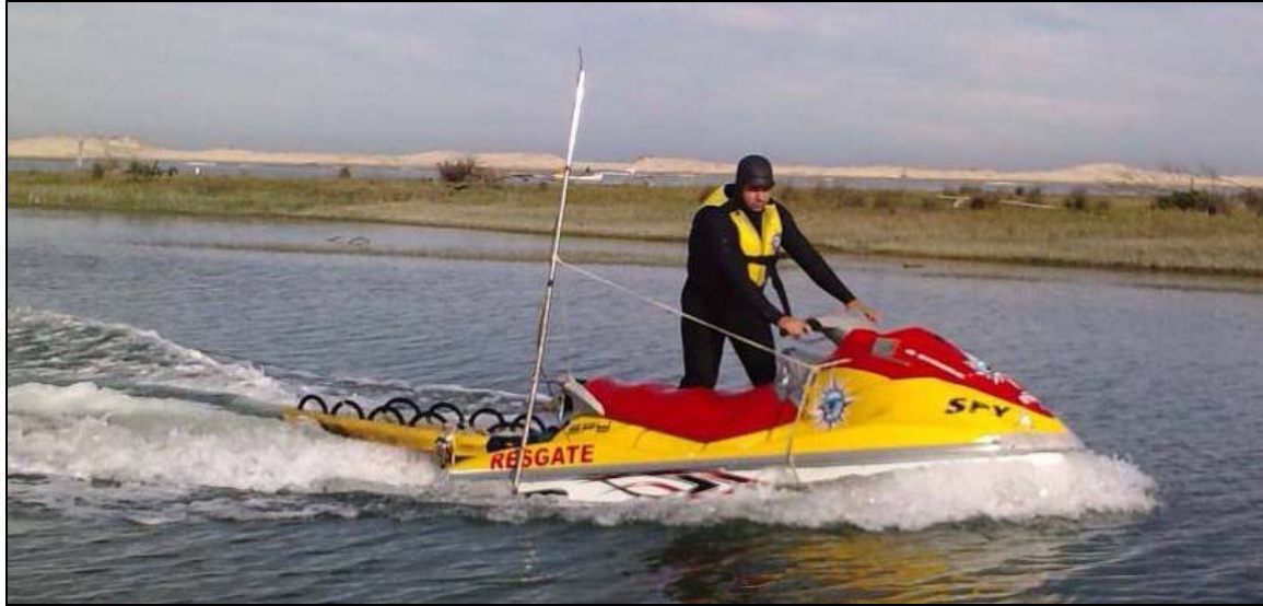
Figura 3: Moto aquática ( jet sky ) utilizada nos levantamentos batimétricos ao largo da praia de Araranguá. É possível observar a haste de suporte do transdutor e antena de transmissão dos dados (x,y e z).
