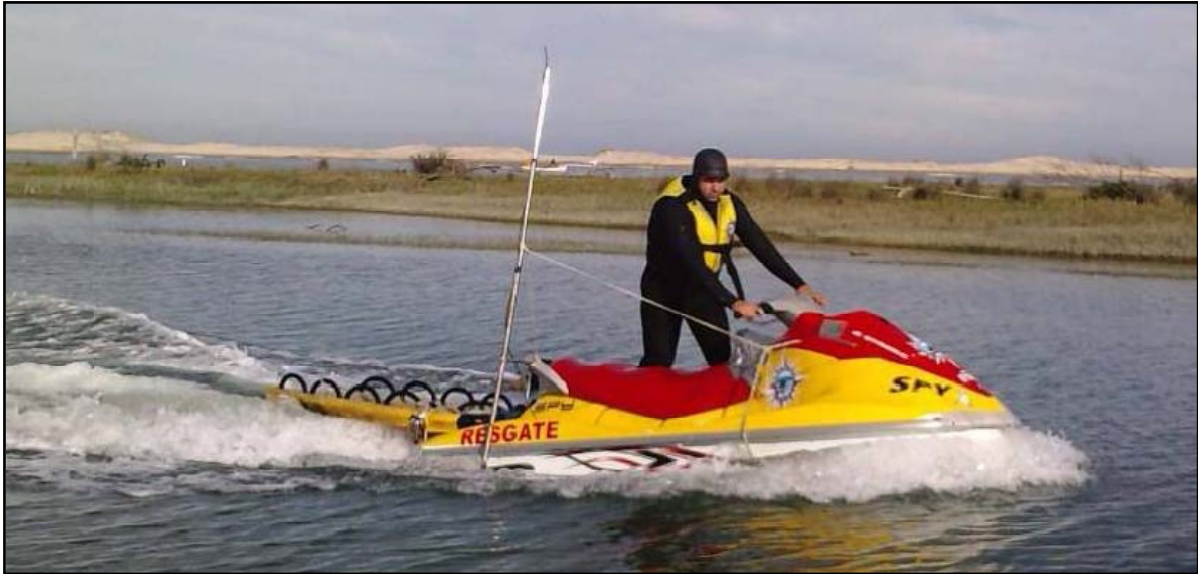
Figura 7: Moto aquática ( jetsky ) utilizada nos levantamentos batimétricos ao largo da praia de Araranguá. É possível observar a haste de suporte do transdutor.
