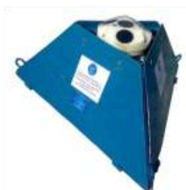
Figura 2. Perfilador de correntes (AWAC®) e CTD utilizado na aquisição dos dados (painel esquerdo) e estrutura de fixação (painel direito).
