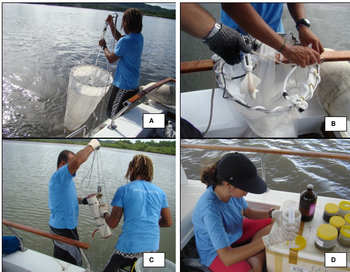
FIGURA 5.2.1.2- 2 – Detalhes da coleta das amostras de plâncton. A – Rede cônica utilizada nos arrastos; B – Colocação do fluxômetro na rede; C – Garrafa amostradora de van Dorn e; D – Preservação das amostras.
