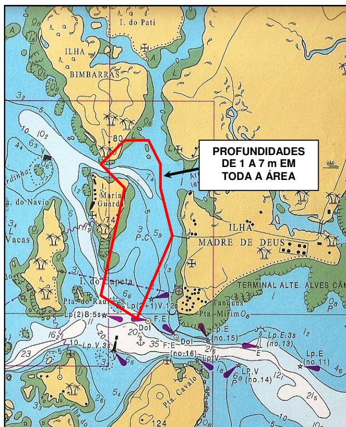
FIGURA 3.1.2- 2 – Extrato da Carta Náutica nº 1.110 mostrando a batimetria da região de Madre de Deus, particularmente no trecho situado ao norte do TEMADRE (Fonte: DHN, 1984).
