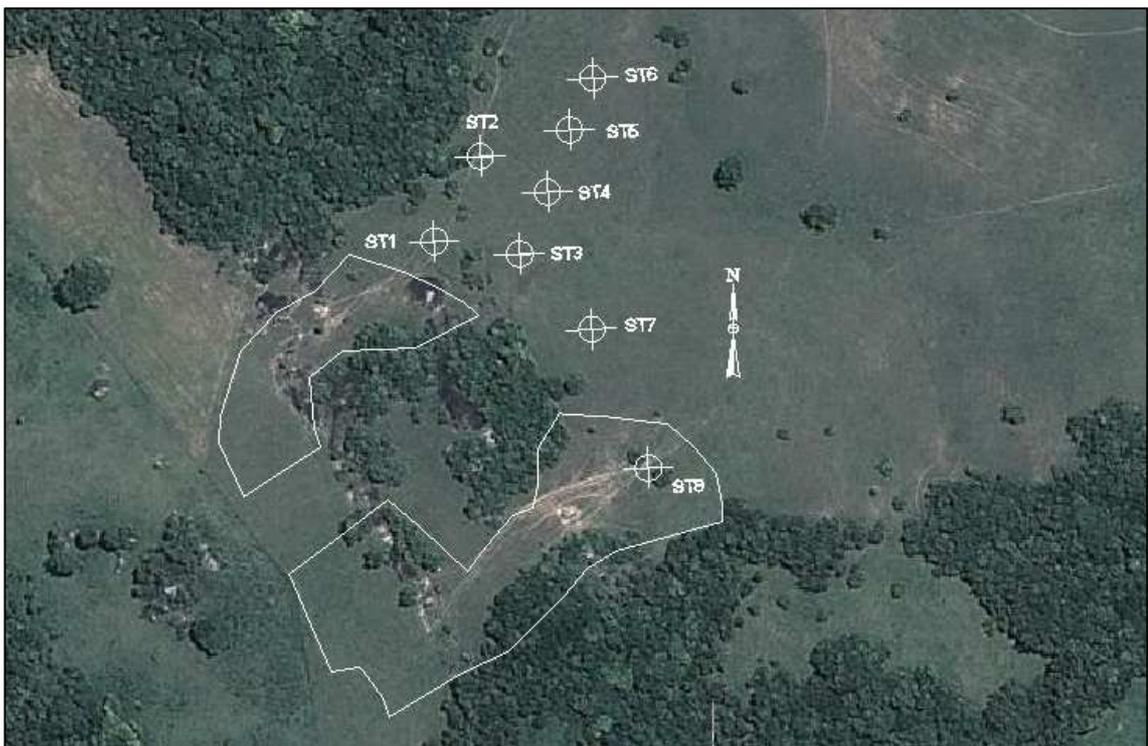
Figura 17. Imagem da localização dos pontos de sondagem realizadas por sondagem a trado. Imagem Google Earth 2013.
