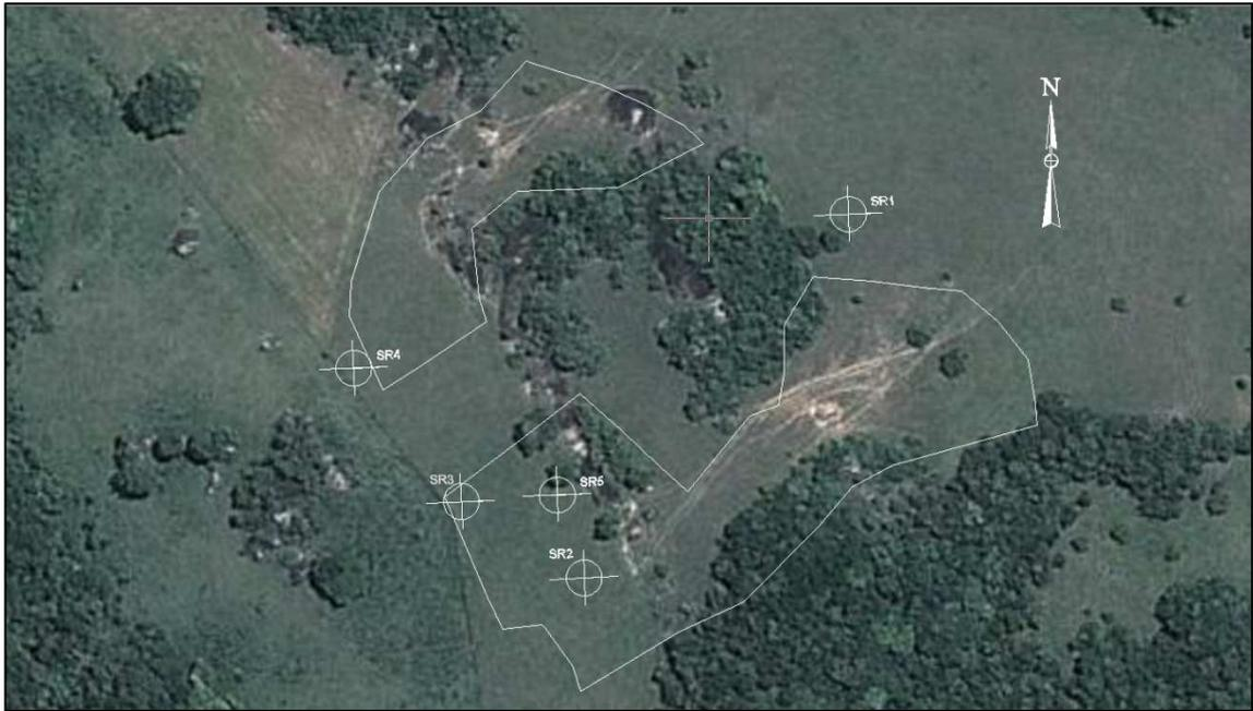
Figura 16. Imagem da localização dos pontos de sondagem realizadas por sondagem rotativa. Imagem Google Earth 2013.
