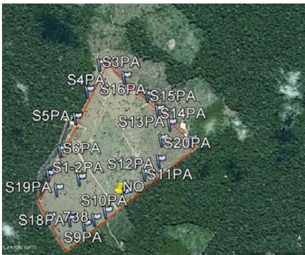
Figura 4.2 – Pontos de Medição de Resistividade Rasa (Werner)
