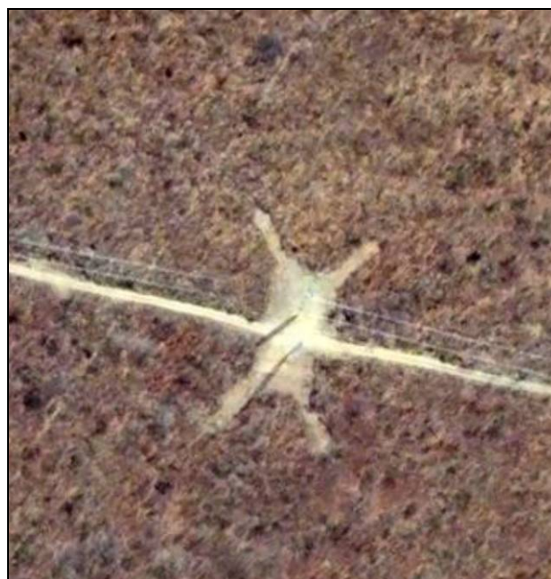
Figura 3.4.7.3.b Exemplo de torre estaiada instalada com mínima supressão de vegetação
