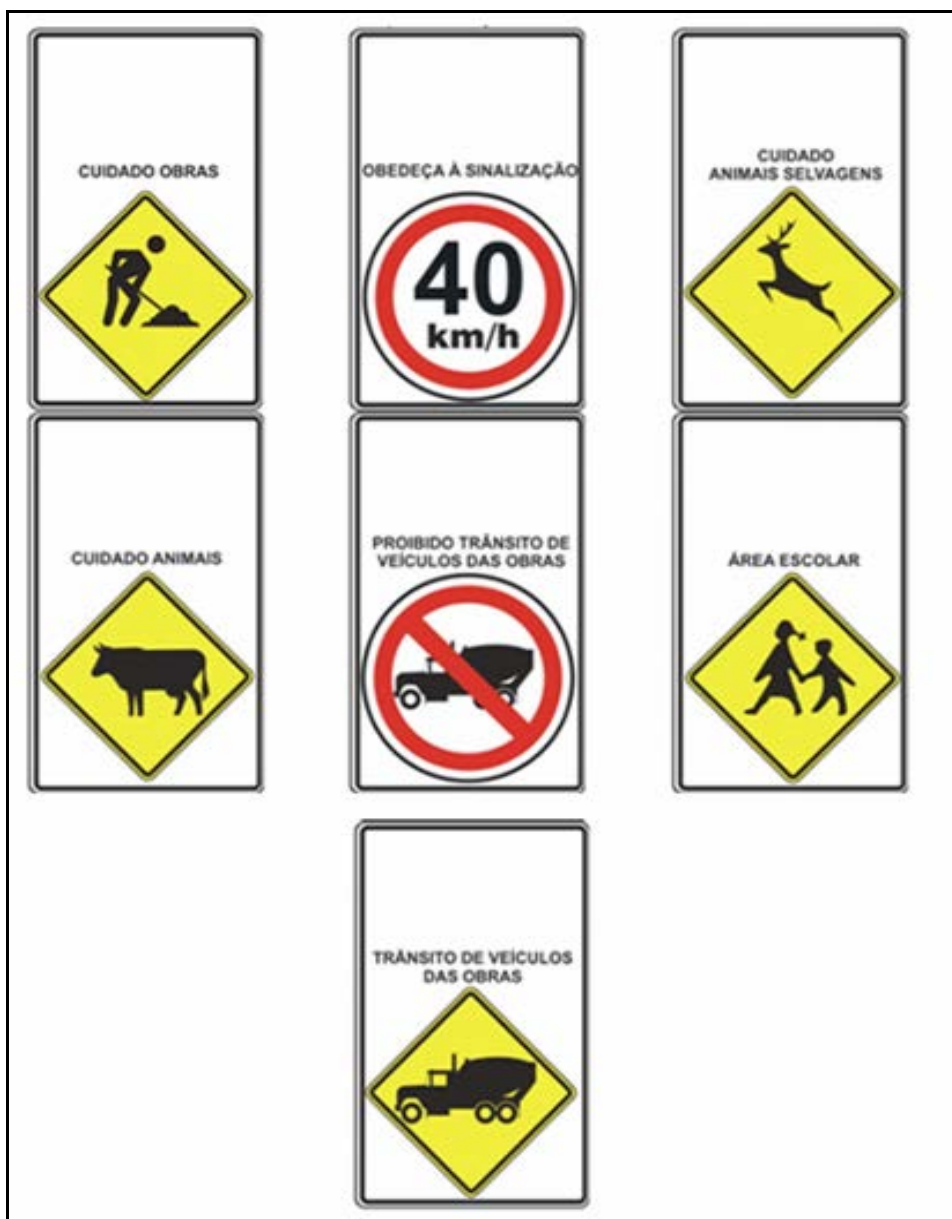
Figura 4.4-2 - Sinalização do Empreendimento
