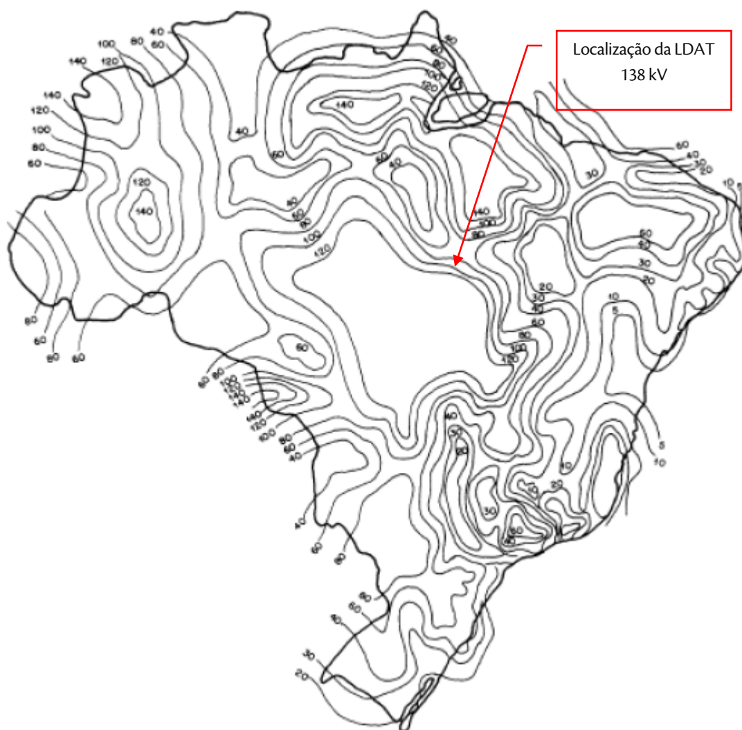
Figura 8. Mapa de curvas isocerâmicas do Brasil com indicação da área de estudo (em vermelho). Fonte: ABNT NBR nº 5419:2001 (adaptado por AMBIENTARE, 2018).
