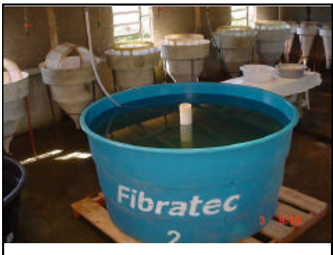
Tanques de larvicultura - Caixas de 2000 litros com entrada (mangueira) e saída de água (cano central)
