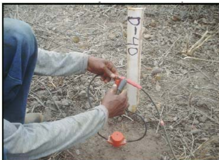
FOTO 2 – Vista do geofone cravado no solo e estaqueamento de campo
