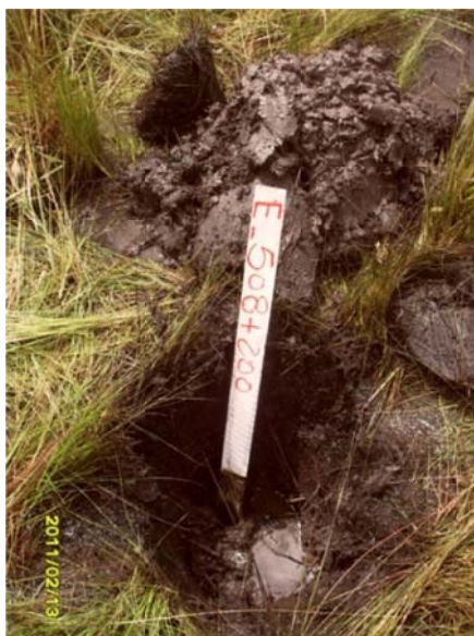
Figura 3.1-3: Detalhe do material dos depósitos aluvionares recentes, característico das várzeas de rio, as margens da primeira travessia do Rio das Fêmeas, no Km 508+200 (esq) e vista do buritizal que recobre a área (dir), marcando o limite da formação geológica.
