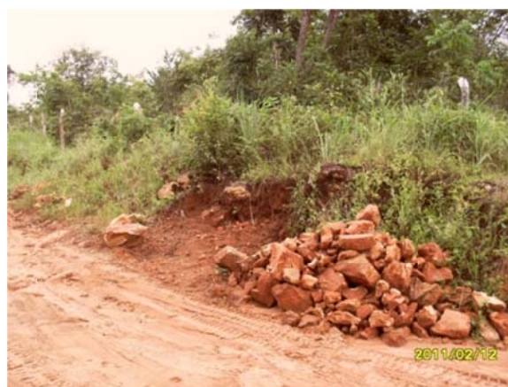
Figura 3.1-2d): Blocos de arenito fino de Formação Urucuia e vista do solo de alteração areno-siltoso avermelhado associado, na estrada marginal ao eixo, na altura do Km 632+500
