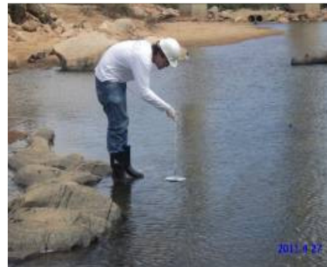
Foto 3-92 – Consultor iniciando processo de medição com Disco de Secchi na montante do rio Pilões.
