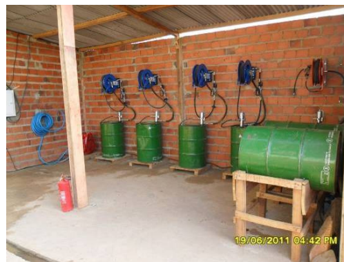
Foto 3-44 Local de lubrificação de máquinas e equipamentos – lote 1.
