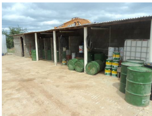
Foto 3-42 Local adequado (impermeável) para o armazenamento de material com potencial contaminante.
