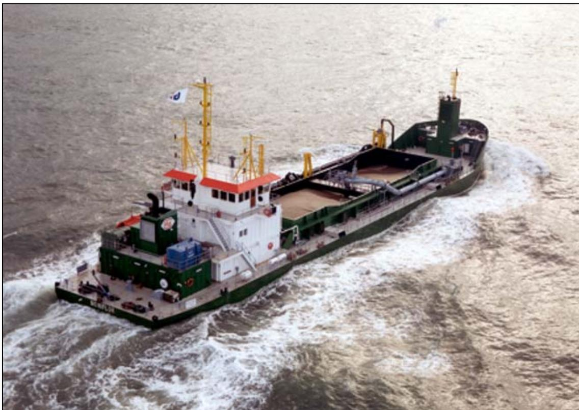
**FIGURA 4.1 1 – Draga auto-transportadora semelhante à que será utilizada pela empresa DRAGAMAR, para extração de sedimentos biodetríticos da Jazida Tutóia (MA).**
