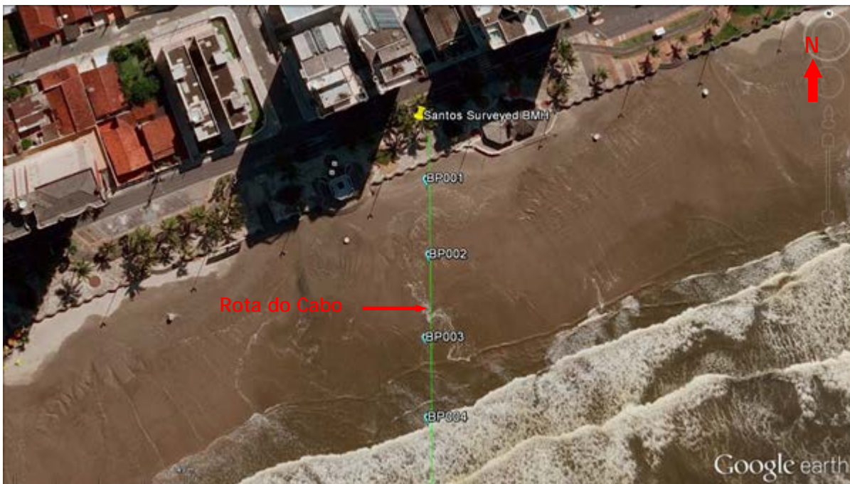
Figura V.1.3-16 - Localização das sondagens realizadas na praia de Praia Grande, com intervalo de 25 m, desde a área da praia mais próxima ao BMH até a linha da maré baixa, ao longo da rota prevista para o Sistema de Cabo Óptico TANNAT.
