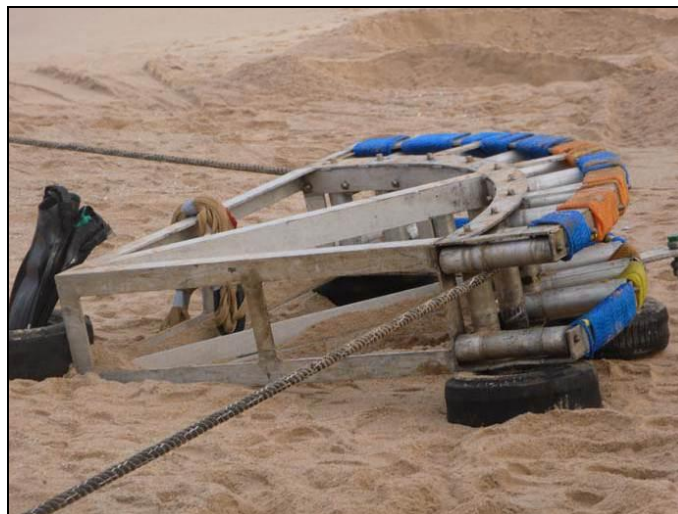
Figura III-15 - Exemplo de quadrante na praia - usado para executar o tracionamento do cabo ao longo da praia.
