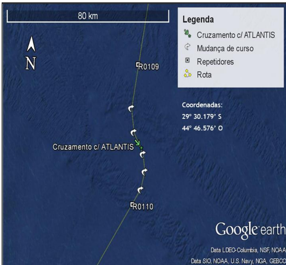
Figura III-19 - Desvio no traçado do Sistema Tannat em decorrência do cruzamento com outro sistema de cabos ópticos.
