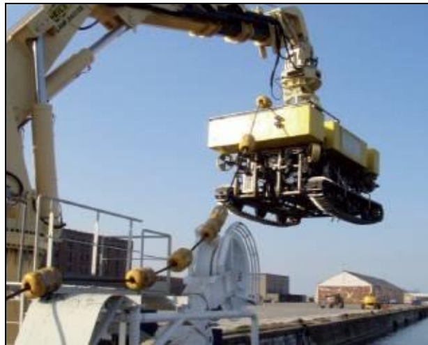
Figura III-11 - Exemplo de ROV utilizado na instalação de cabos submarinos pela ASN.
