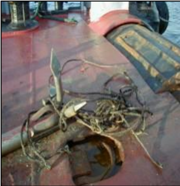
Figura III-25 - Fateixa típica utilizada na remoção de detritos do leito oceânico antes da operação de enterramento do cabo submarino.
