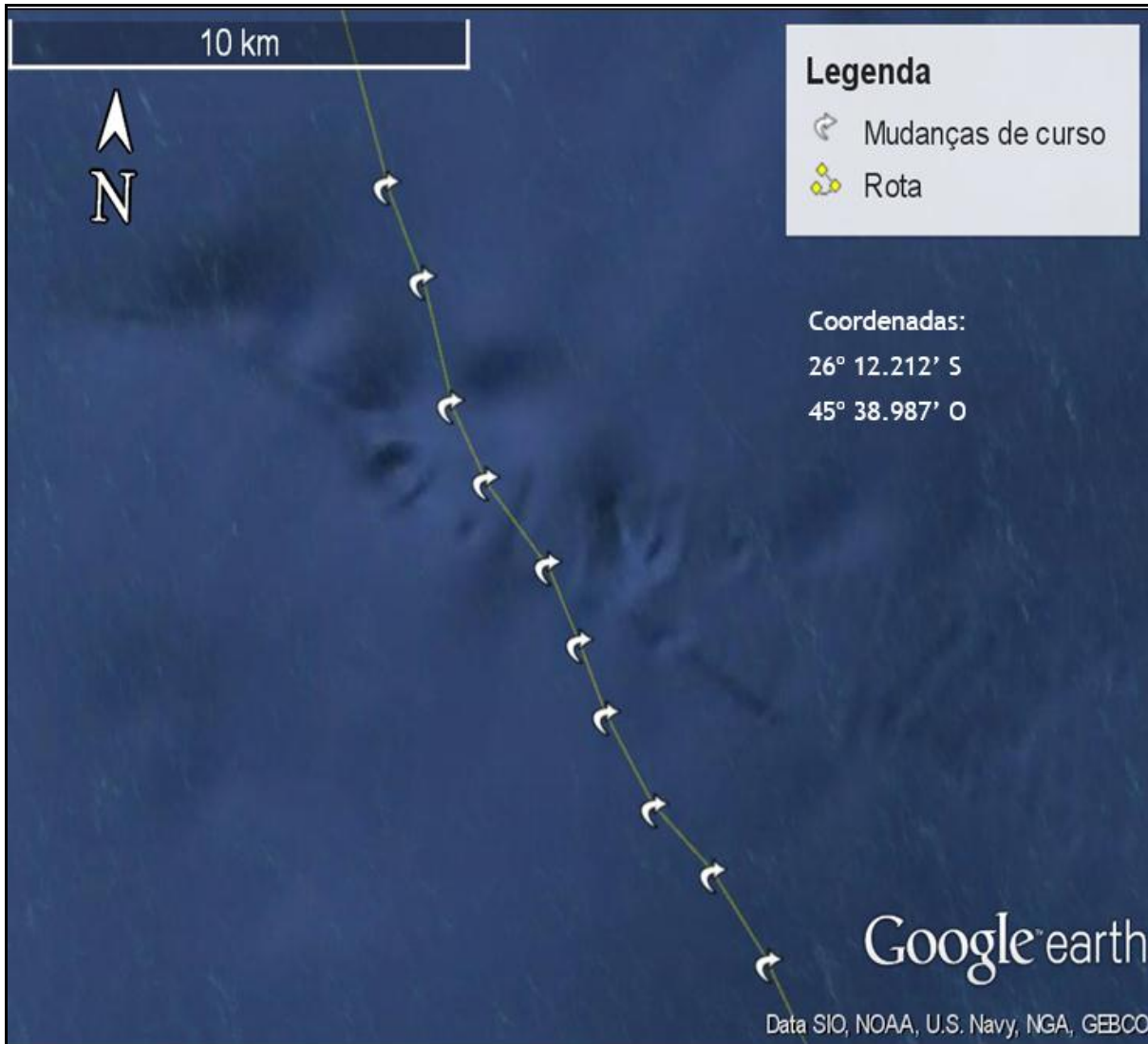
Figura III-20 - Ajustes na rota do Sistema Tannat feitos a partir de informações detalhadas do relevo do fundo oceânico.
