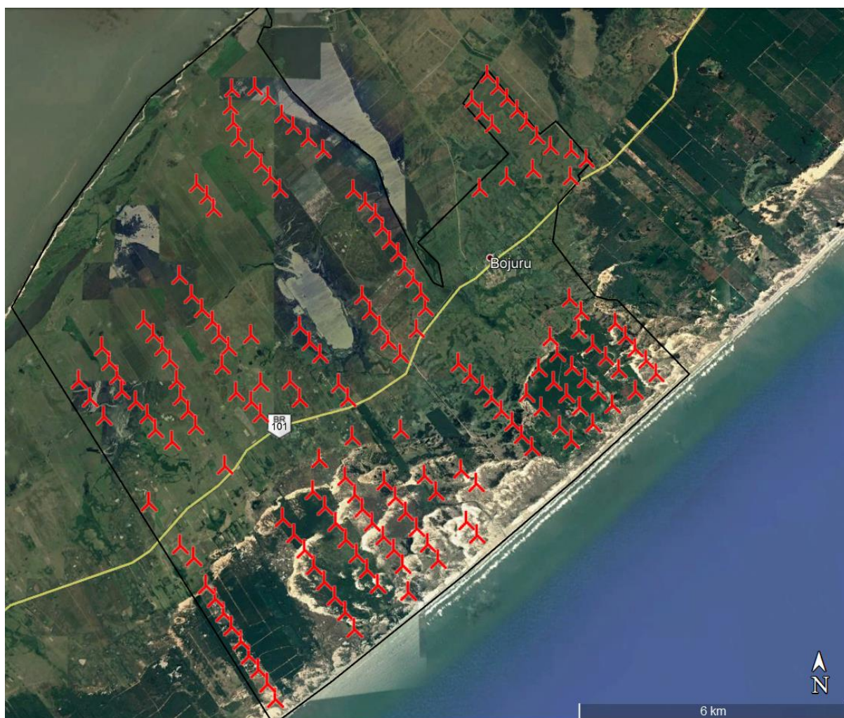
Figura 2.15 - Alternativa 3 – 173 Aerogeradores GAMESA G114 – 454,1 MW
