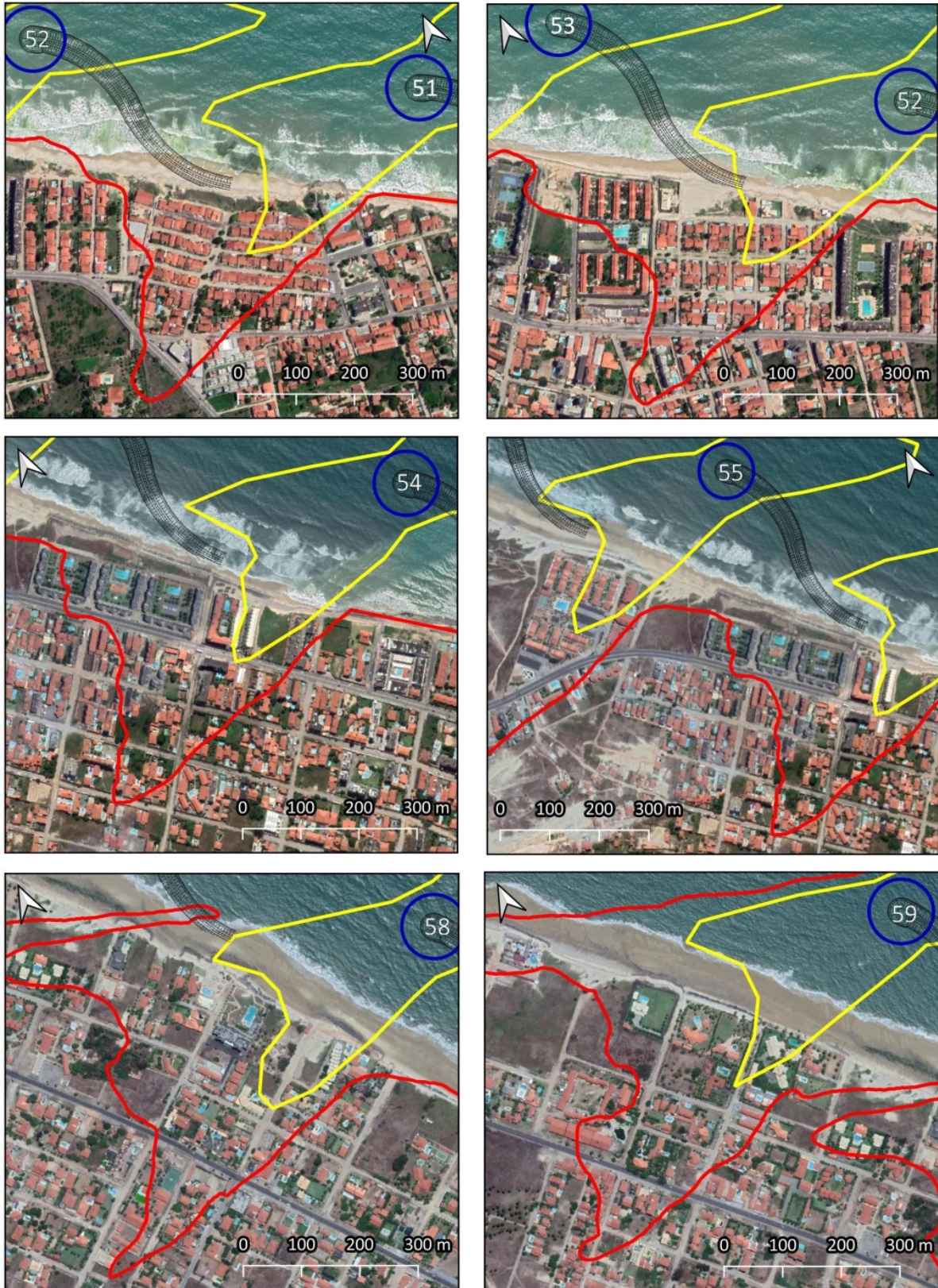
Figura 10. Detalhe de áreas de incidência de sombras em períodos de 30 a 99 h/ano (limite vermelho) e acima de 100 h/ano (limite amarelo), resultantes da movimentação das pás dos aerogeradores semioffshore do Parque eólico Caucaia.
