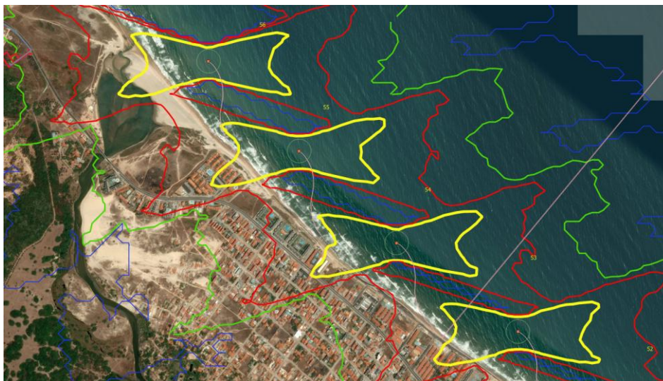
Figura 7 - Detalhes dos cones de sombreamento em ortofotos, estimado em condições de "worst case" para usina eólica Parte On-shore (próximo da costa) – Entre as turbinas n.56 e n.53 (Turbinas mais ao norte).
