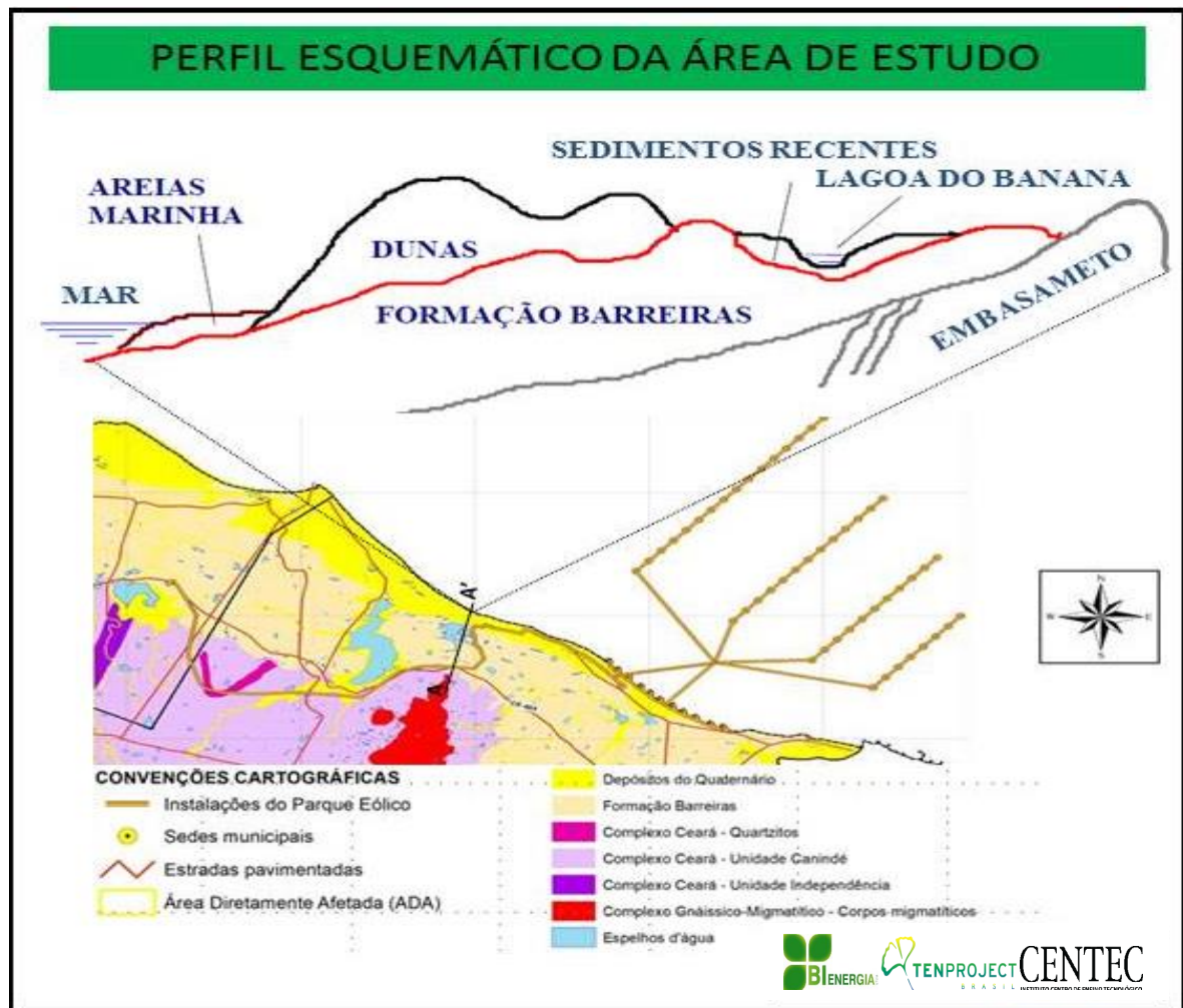
Figura 4.1.4.4.2.5 - Perfil geológico esquemático da área do Projeto Eólico no município da Caucaia.
