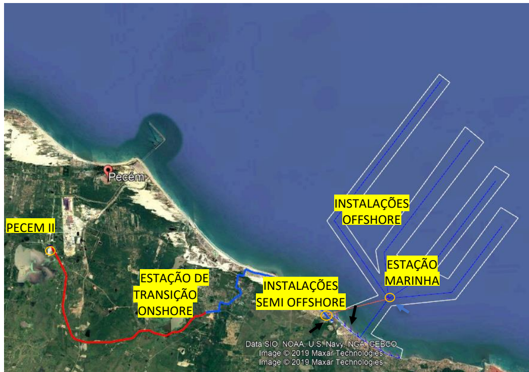
Figura 2.1.6 - Identificação das obras de conexão.
