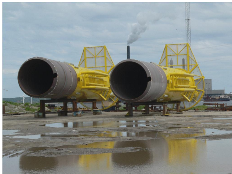
Figura 2.5.2.1.89 - Estocagem dos elementos de transição.
