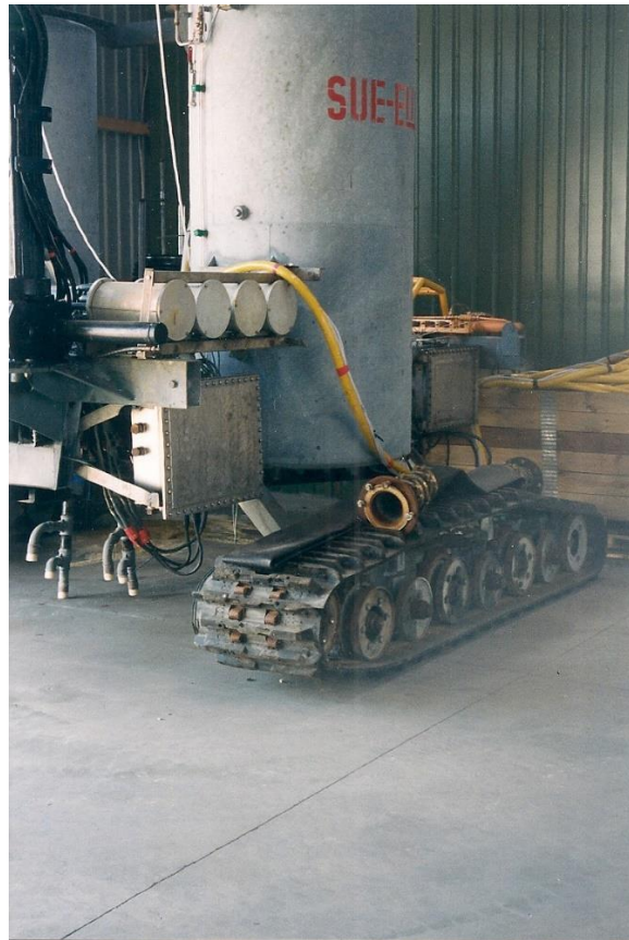
Figura 2.5.2.1.43 - Equipamento para escavação de vala em solo submarino arenoso
