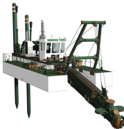
Figura 2.5.2.1.58 - Draga de sucção hidráulica com disruptor
