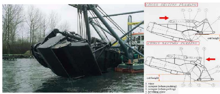
Figura 2.5.2.1.62 - Draga scoop dredger
