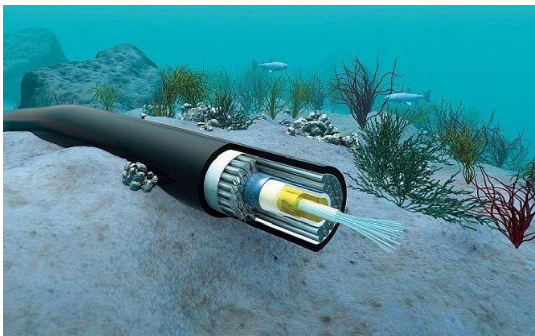
Figura 2.5.2.1.101 - Esquema tipológico de cabo marinho reforçado
