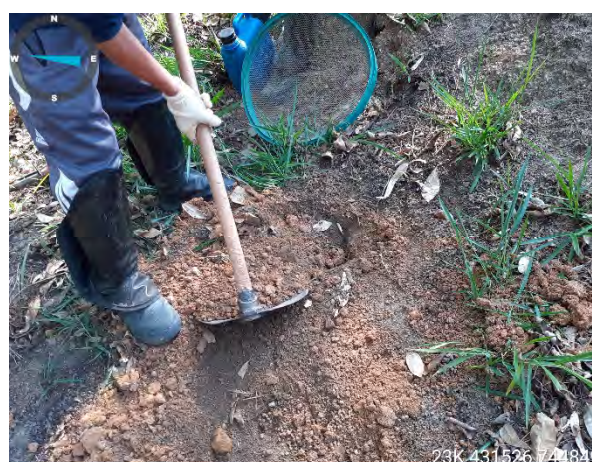
Figuras 4.28 e 4.29: Fechamento da unidade interventiva com utilização do próprio sedimento ora extraído (PT's 023 e 042, respectivamente).
