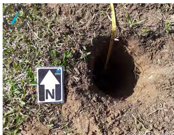
Figuras 4.26 e 4.27: Aferição com trena das profundidades alcançadas (PT's 015 e 080, respectivamente).
