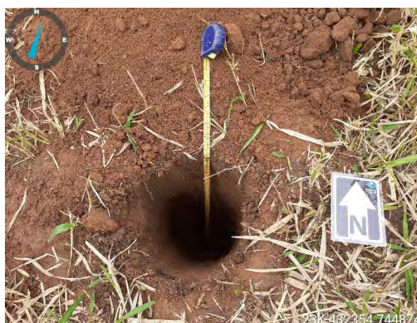
Figuras 4.26 e 4.27: Aferição com trena das profundidades alcançadas (PT's 015 e 080, respectivamente).
