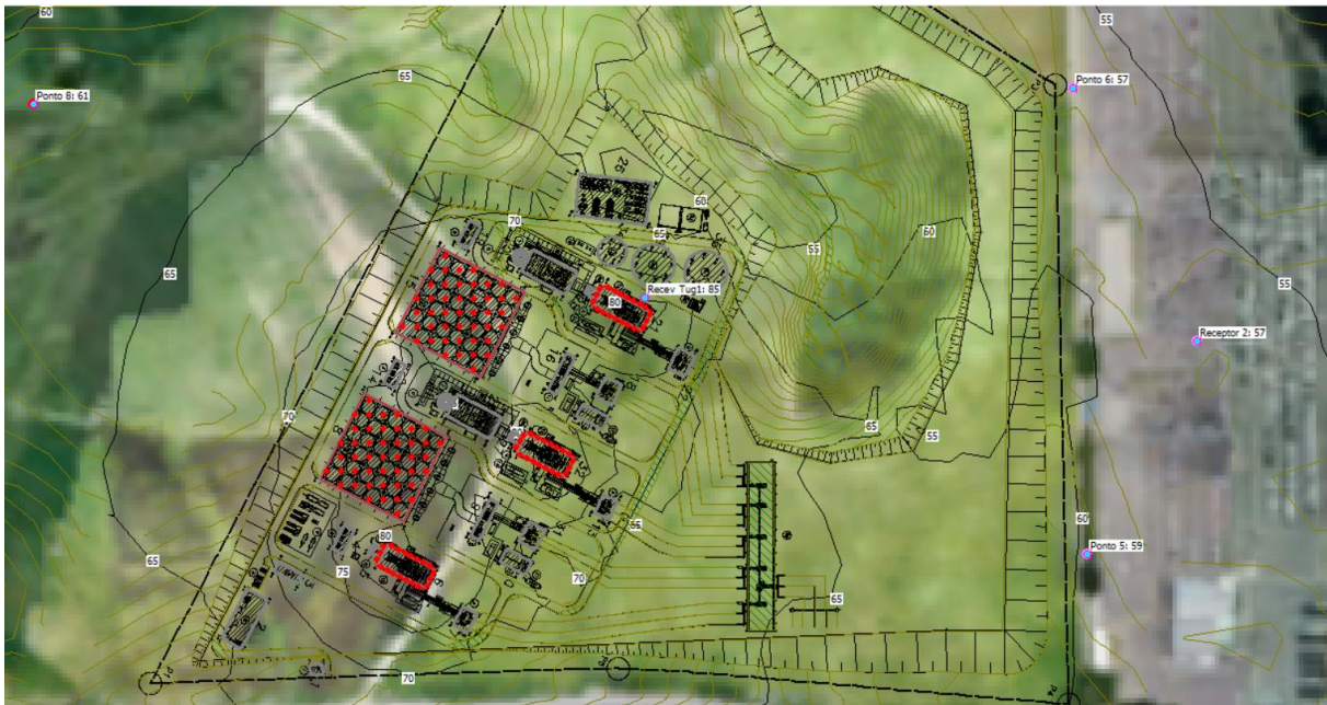
Figura 8.5.25 - Modelo 2D da planta de instalação da UTE São Paulo com destaque para os pontos receptores, terreno e as empresas no entorno. Os traçados em vermelho são referentes às principais fontes de emissão de ruído da UTE, já os traçados em cinza são referentes às construções que interferem na dissipação do ruído no entorno.
