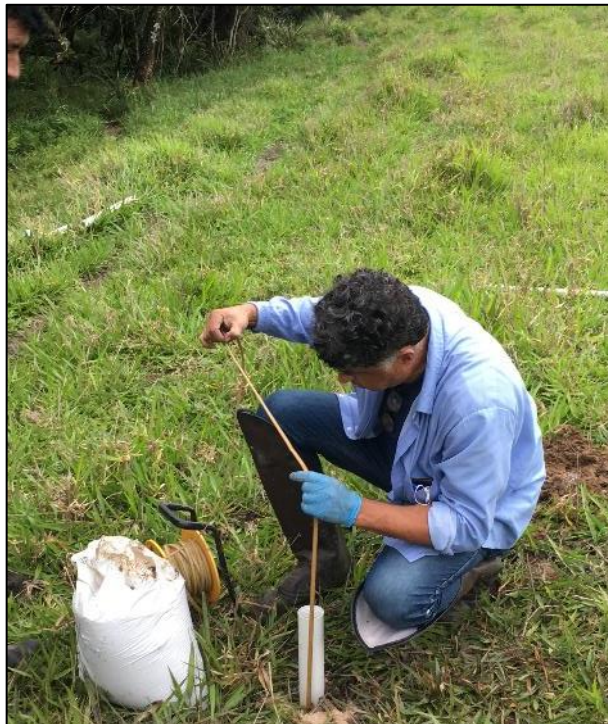
Figura 6.1.71 – Medição do nível d'água dinâmico após a instalação do PM-01
