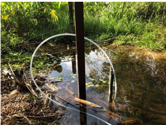
Figura 6.1.102 - Piezômetro diferencial dentro do afloramento
