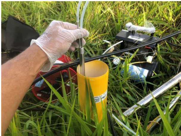
Figura 6.1.73 – Coleta de amostra de baixa vazão com bomba pneumática.
