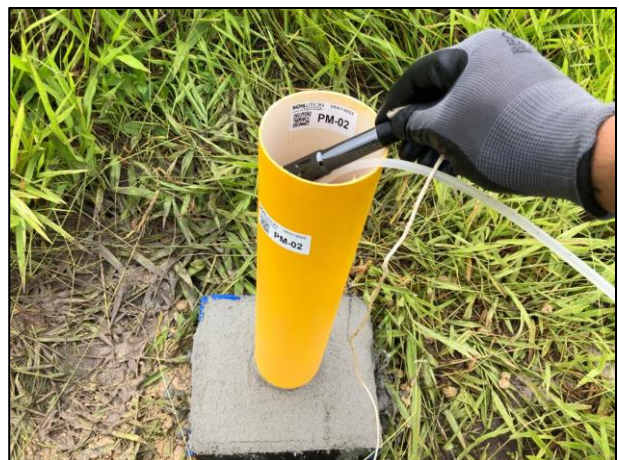
Figura 6.1.76 – Introdução do transdutor automático em poço de monitoramento PM-02
