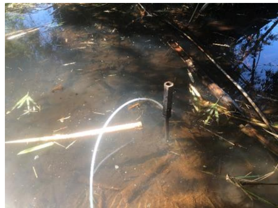
Figura 6.1.101 – Piezômetro diferencial instalado dentro do afloramento
