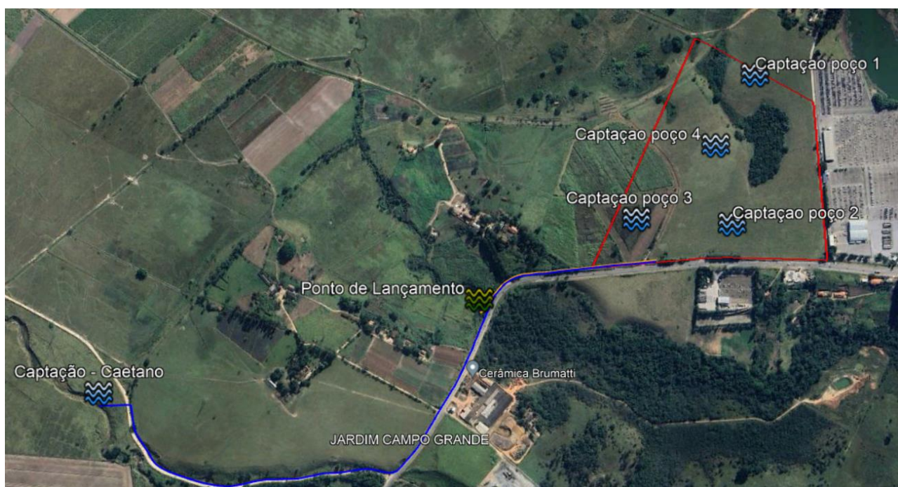
Figura 4.5.1 – Tubulação de captação de água do Rio Caetano e poços Fonte: Memorial Descritivo Tractebel (Anexo V)
