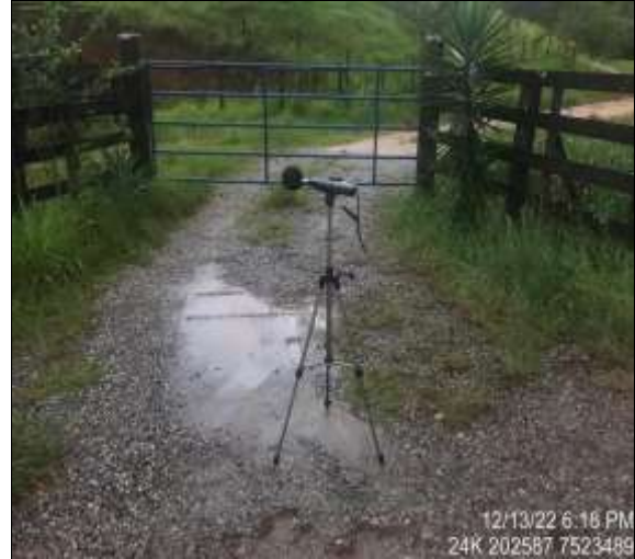
Figura 6.1-142 - Equipamento posicionado para aferição dos níveis de pressão sonora no NPS07 no período noturno.
