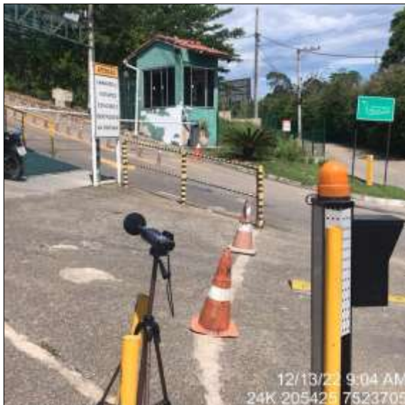
Figura 6.1-135 - Equipamento posicionado para aferição dos níveis de pressão sonora no NPS04 no período diurno.
