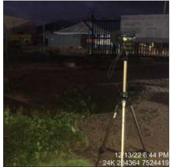
Figura 6.1-130 - Equipamento posicionado para aferição dos níveis de pressão sonora no NPS01 no período noturno.
