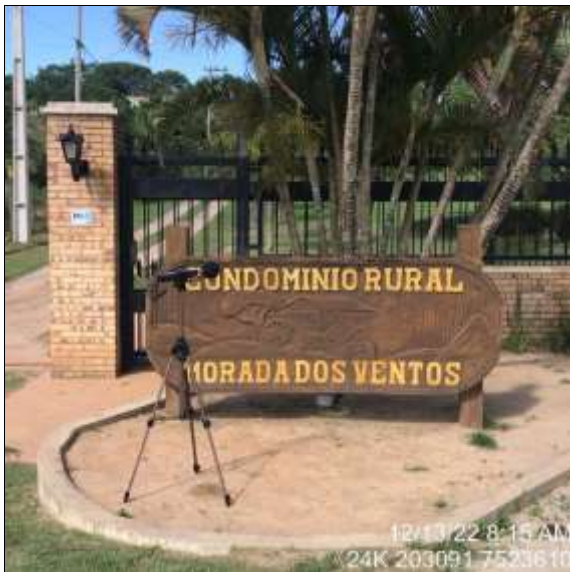
Figura 6.1-139 - Equipamento posicionado para aferição dos níveis de pressão sonora no NPS06 no período diurno.
