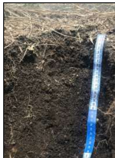
Figura 6.1-12 - Perfil de Organossolo Háplico em relevo plano da baixada do rio Macaé. Município: Macaé – RJ. Coord. UTM – Zona 24S - E: 203.625 N: 7.532.781 alt.: 5 metros.
