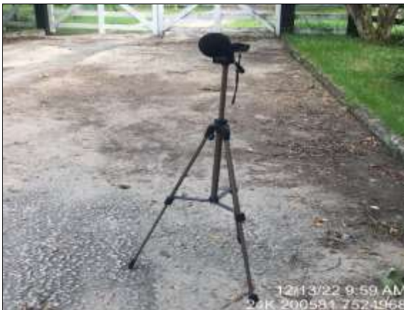
Figura 6.1-147 - Equipamento posicionado para aferição dos níveis de pressão sonora no NPS10 no período diurno.
