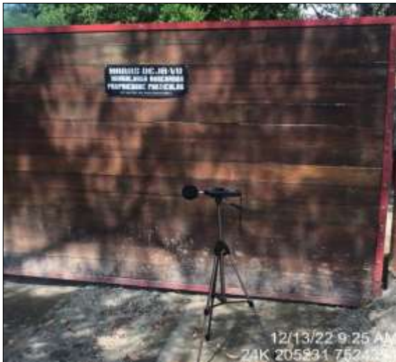
Figura 6.1-131 - Equipamento posicionado para aferição dos níveis de pressão sonora no NPS02 no período diurno.
