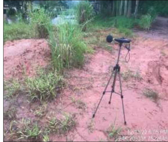
Figura 6.1-138 - Equipamento posicionado para aferição dos níveis de pressão sonora no NPS05 no período noturno.
