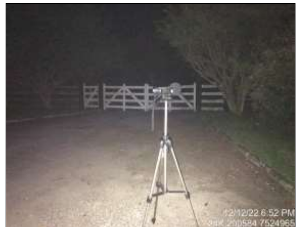
Figura 6.1-148 - Equipamento posicionado para aferição dos níveis de pressão sonora no NPS10 no período noturno.
