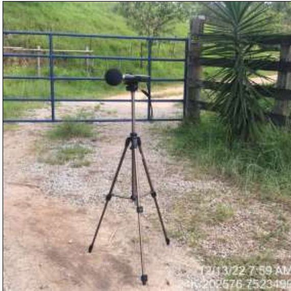
Figura 6.1-141 - Equipamento posicionado para aferição dos níveis de pressão sonora no NPS07 no período diurno.
