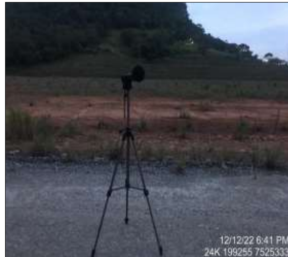
Figura 6.1-150 - Equipamento posicionado para aferição dos níveis de pressão sonora no NPS11 no período noturno.
