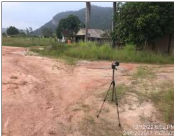
Figura 6.1-143 - Equipamento posicionado para aferição dos níveis de pressão sonora no NPS08 no período diurno.
