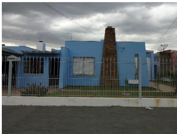
Foto 6.5-78 - Casa com baixo padrão construtivo, com estrutura e vedação de madeira. Estado de conservação mediano.
