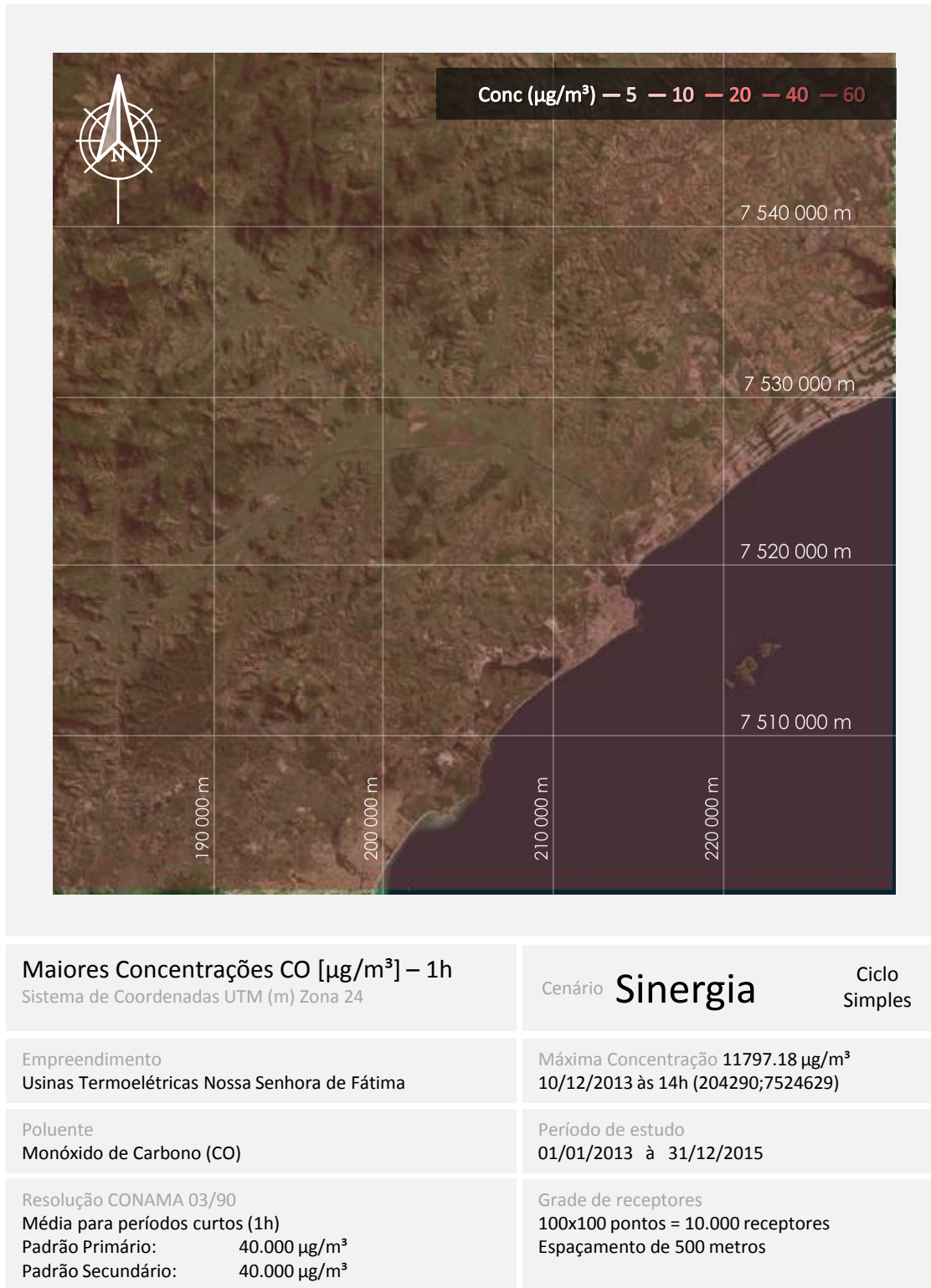
Figura 36 – Mapa com as maiores concentrações médias de horárias simuladas. Poluente CO, Cenário Sinergia, Ciclo Simple.
