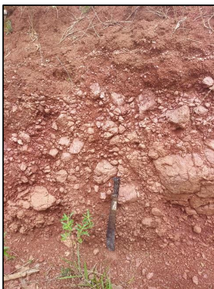
Foto 5. Perfil de solo na área de estudo com elevado estágio de alteração da rocha mãe. Localização: -20,722028° / -43,876610°.
