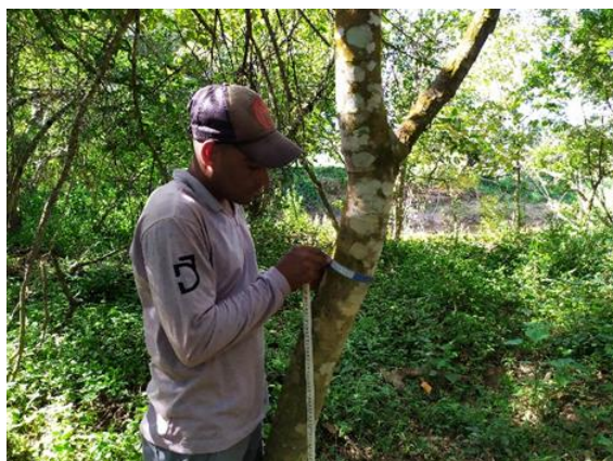
Foto 18. Detalhe da medida de CAP com fita métrica comum.
