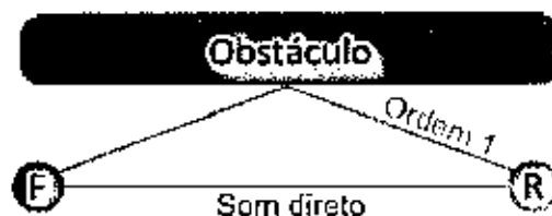
Figura 3 - Propagação do som entre uma fonte F e um receptor R, com reflexão de primeira ordem
