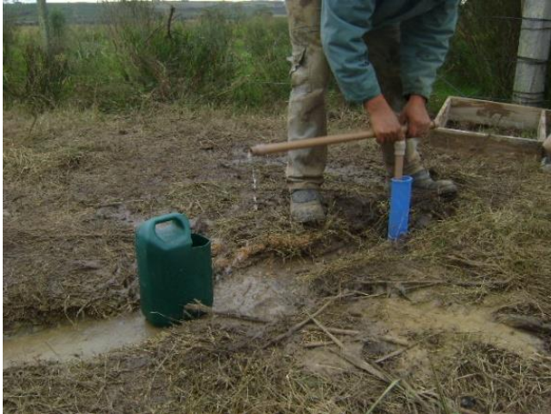
Figura 5.18 - Ensaio de Permeabilidade realizado no PM01B.
