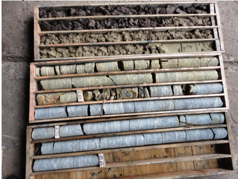
Figura 5.3 - Testemunhos de sondagem da formação Palermo do furo de sondagem PM03B, executada no local previsto para a construção da usina.
