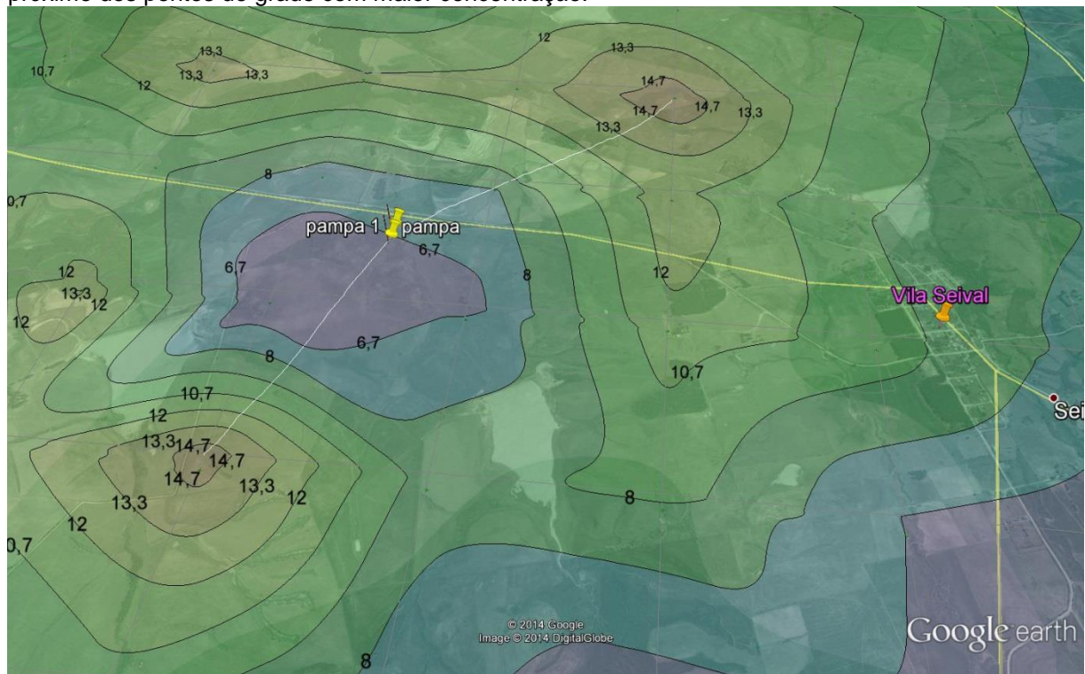
Figura 5.85 - Isolinhas de concentração de SO 2 , sobreposta no google earth, considerando um zoom próximo dos pontos de grade com maior concentração.
