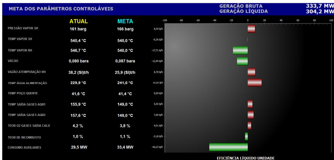
Figura 2 - Monitoramento dos parâmetros controláveis e sua comparação com valores meta (figura ilustrativa).
