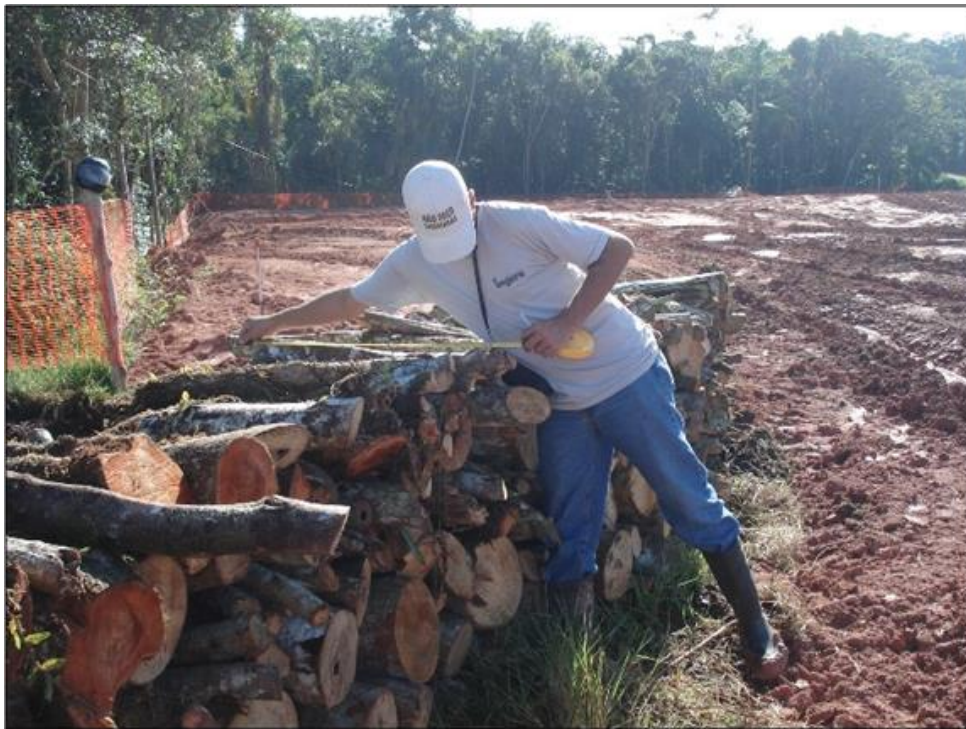
Figura 02 - Exemplo de medição de conferência da largura das pilhas (Fonte: Perin, R.G., 2012).
