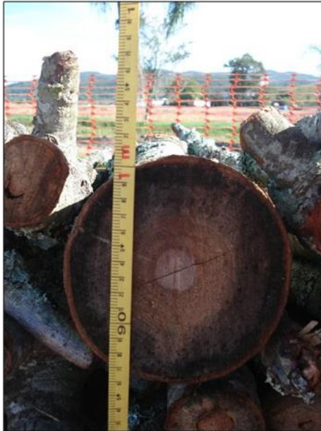
Figura 03 - Exemplo de medição de conferência da altura das pilhas (Fonte: Perin, R.G., 2012).
