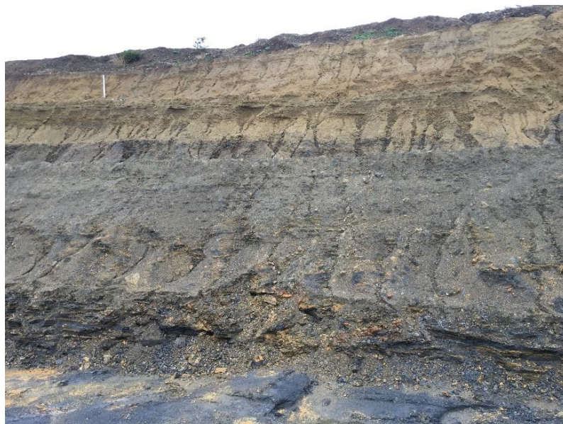
Figura 5: Vista de um grande talude situado próximo ao eixo principal da barragem destacando a presença de sedimentação paleozoica com camadas alternadas de argilitos, siltitos cinza claros a escuros, com coordenadas geográficas 31^{\circ}29'7,55'' ; 53^{\circ}49'20,75'' .
