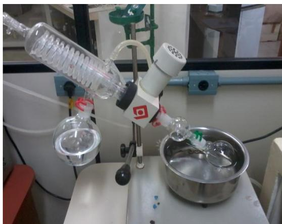
Figura 3: Rotaevaporador para concentrar a amostra
