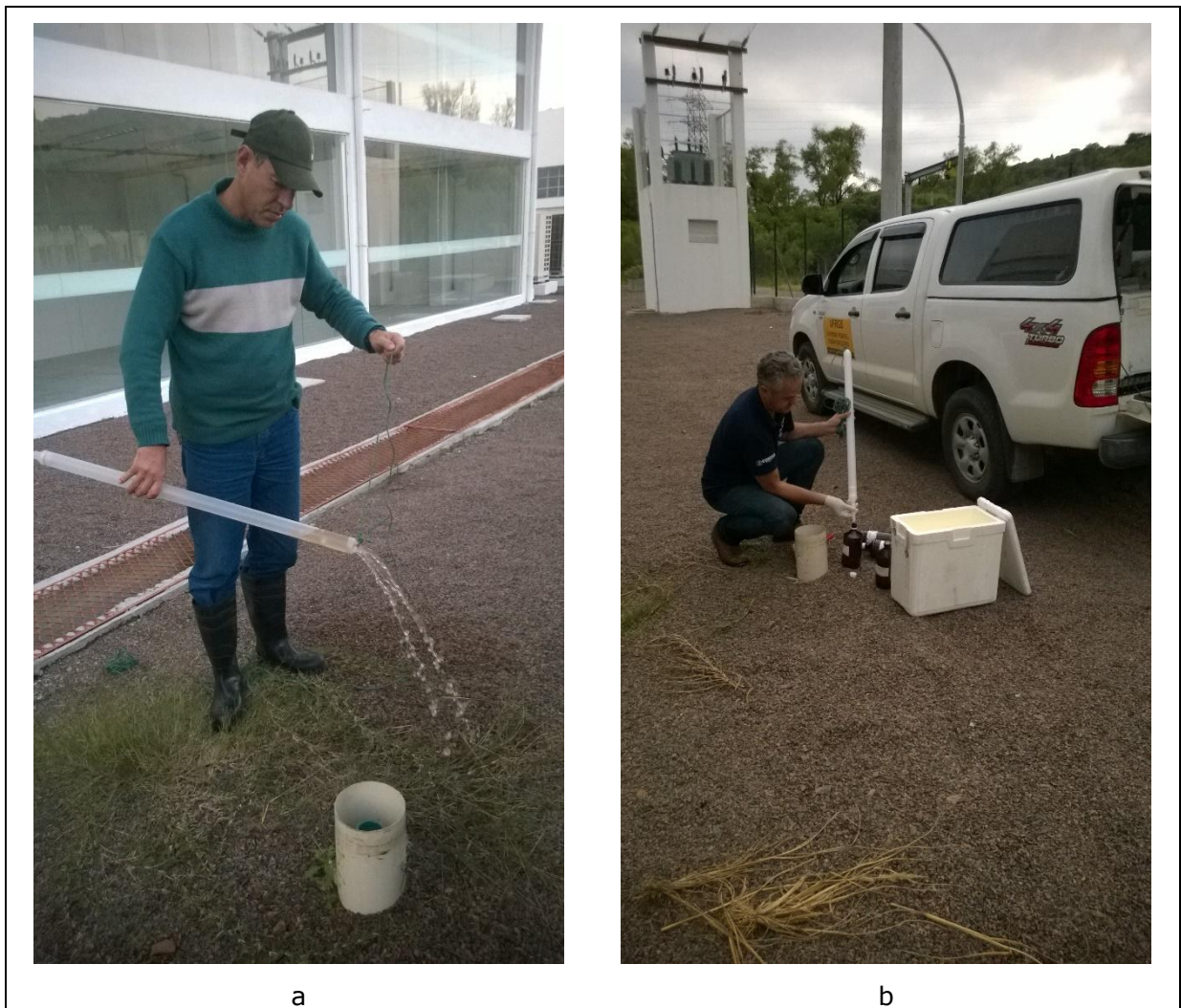
Figura 6. Esgotamento e coleta do poço PM-16, realizados nos dias 02 3 03 de junho de 2015 com amostrador descartável tipo bailer . Note-se a fraca turbidez na água do poço.
