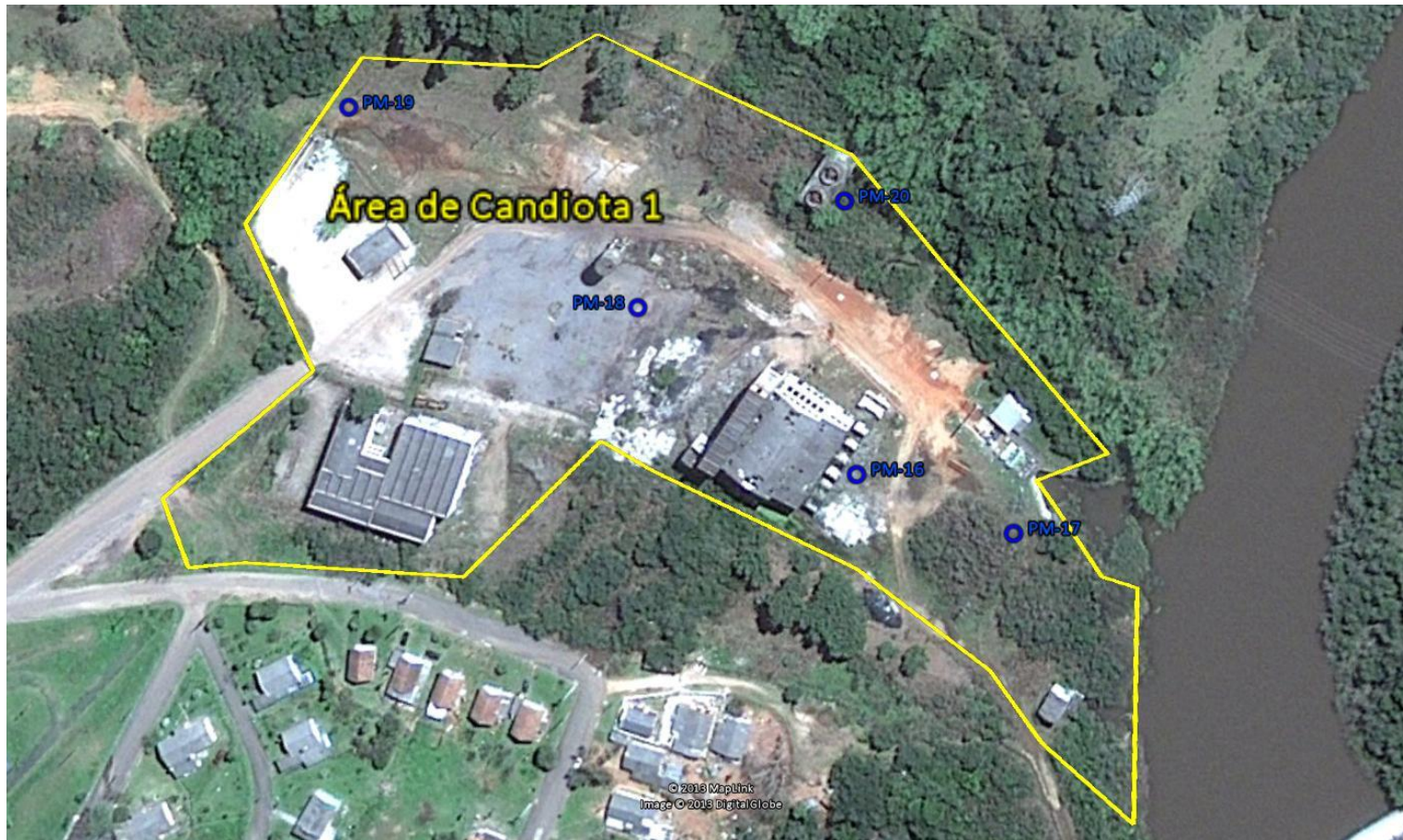
Figura 4. Localização dos poços de monitoramento da área de Candiota 1. O poço PM-18 foi danificado por obras de terraplanagem realizadas no local e excluído da rede de monitoramento.
