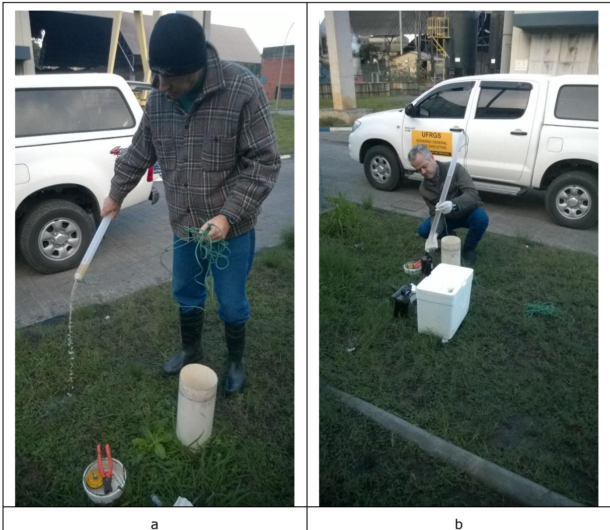
Figura 10. Esgotamento e coleta do poço PM-02, realizados nos dias 02 3 03 de junho de 2015 com amostrador descartável tipo bailer . Note-se a significativa turbidez da água do poço.
