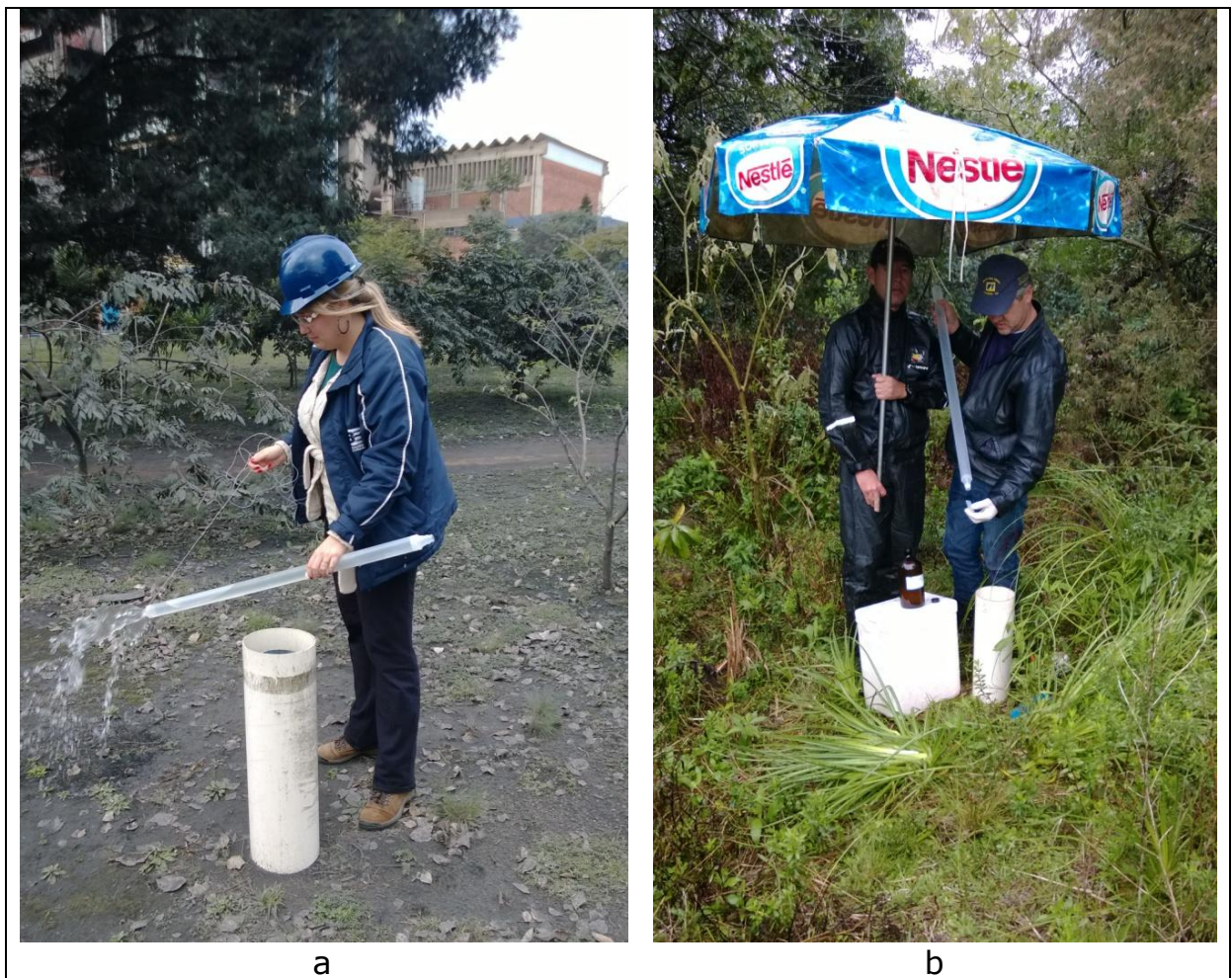
Figura 7. Esgotamento do poço PM-1 (a) e coleta no poço PM-7 (b), realizado na primeira campanha amostral, nos dias 29 e 30 de julho de 2014, com amostrador descartável tipo beiler .
