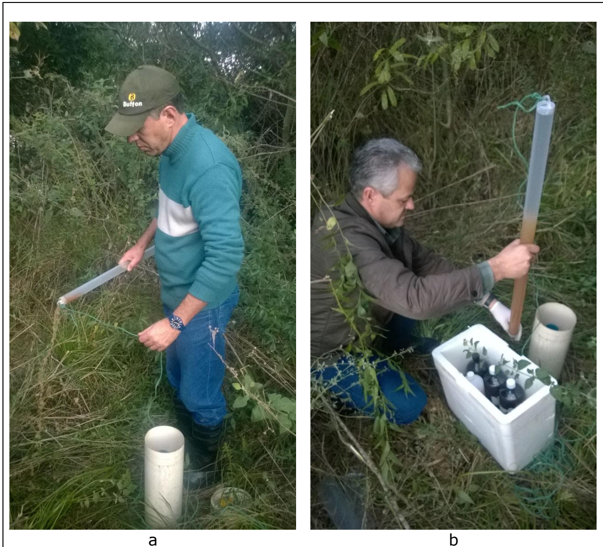
Figura 10. Esgotamento e coleta do poço PM-17, realizados na quarta campanha amostral, nos dias 02 e 03 de junho de 2015, com amostrador descartável tipo bailer . Note-se a forte turbidez na água do poço.
