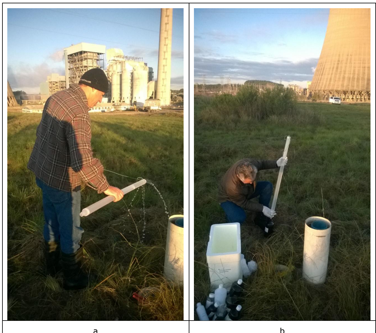
Figura 12. Esgotamento e coleta do poço PM-10, realizados na quarta campanha amostral, nos dias 02 e 03 de junho de 2015, com amostrador descartável tipo bailer . Note-se a limpidez da água do poço.
