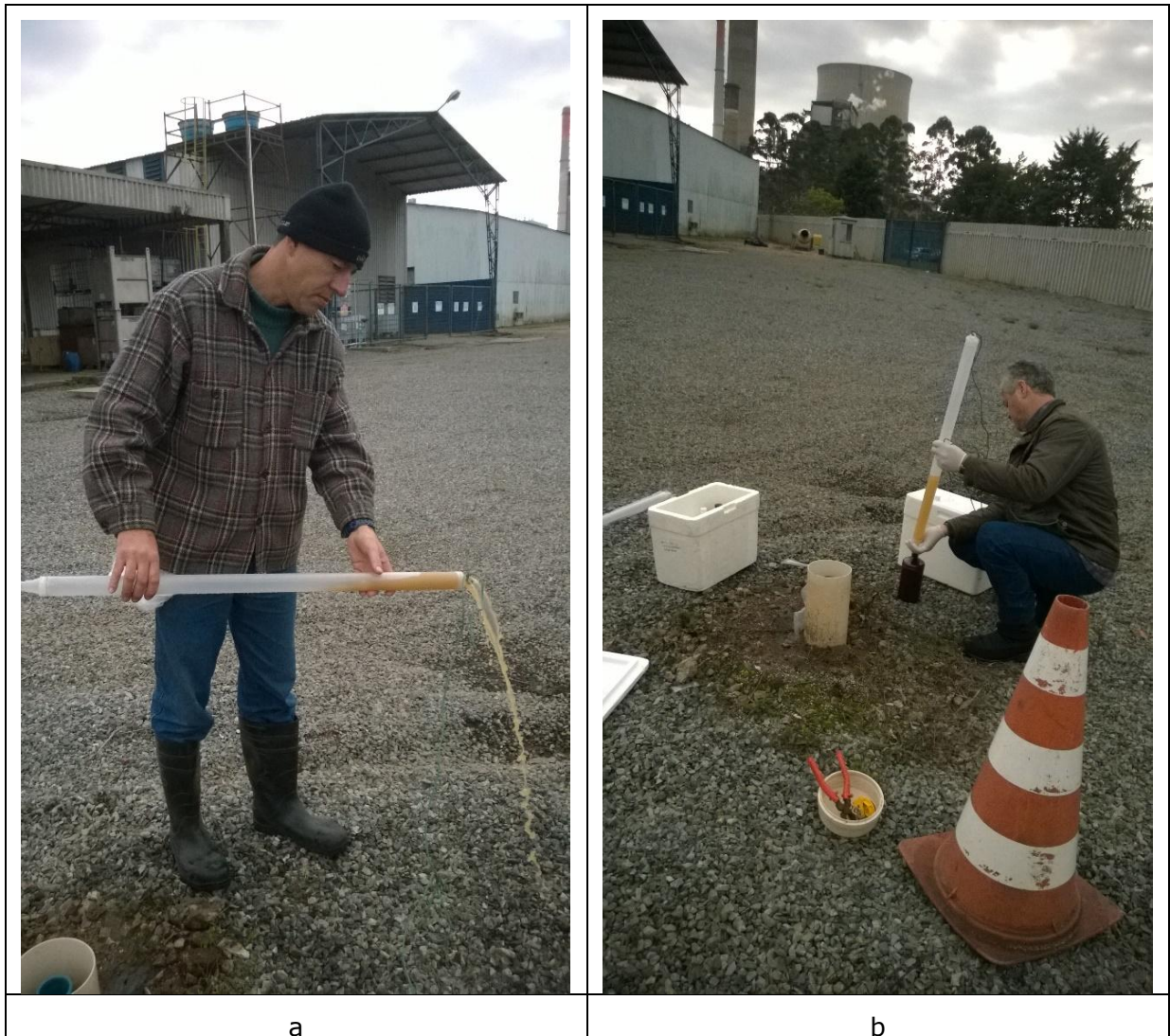
Figura 14. Esgotamento e coleta do poço PM-13, realizados na quarta campanha amostral, nos dias 02 e 03 de junho de 2015, com amostrador descartável tipo bailer . Note-se a significativa turbidez da água do poço.
