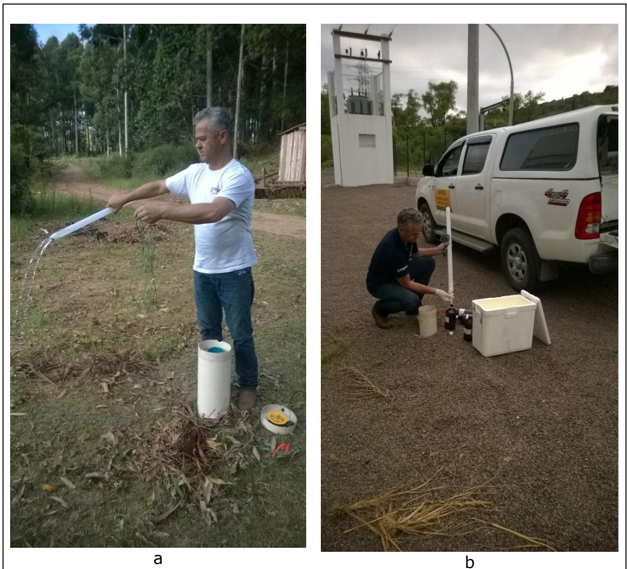
Figura 9. Esgotamento do poço PM-5 (a) e coleta no poço PM-15 (b), realizados na terceira campanha amostral, nos dias 03 e 04 de fevereiro de 2015, com amostrador descartável tipo beiler .
