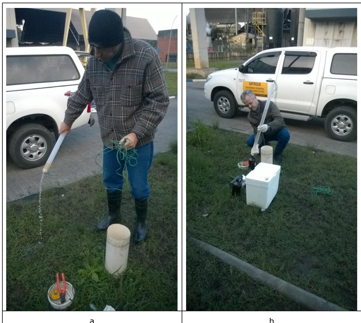
Figura 15. Esgotamento e coleta do poço PM-02, realizados na quarta campanha amostral, nos dias 02 e 03 de junho de 2015, com amostrador descartável tipo bailer . Note-se a significativa turbidez da água do poço.
