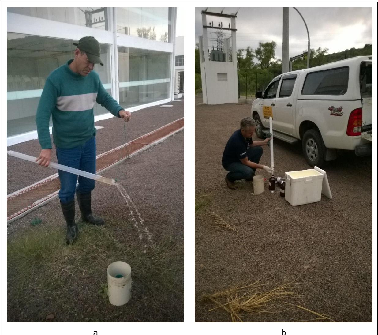
Figura 11. Esgotamento e coleta do poço PM-16, realizados na quarta campanha amostral, nos dias 02 e 03 de junho de 2015, com amostrador descartável tipo bailer . Note-se a fraca turbidez na água do poço.
