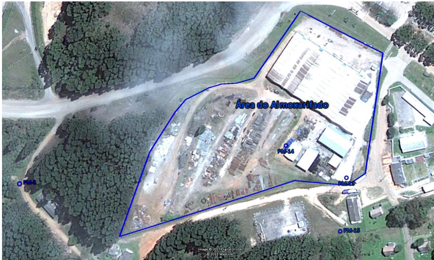
Figura 3. Localização dos poços de monitoramento da área do Almoxarifado. O poço PM-15 foi destruído por obras de terraplanagem realizadas no local e excluído da rede de monitoramento.
