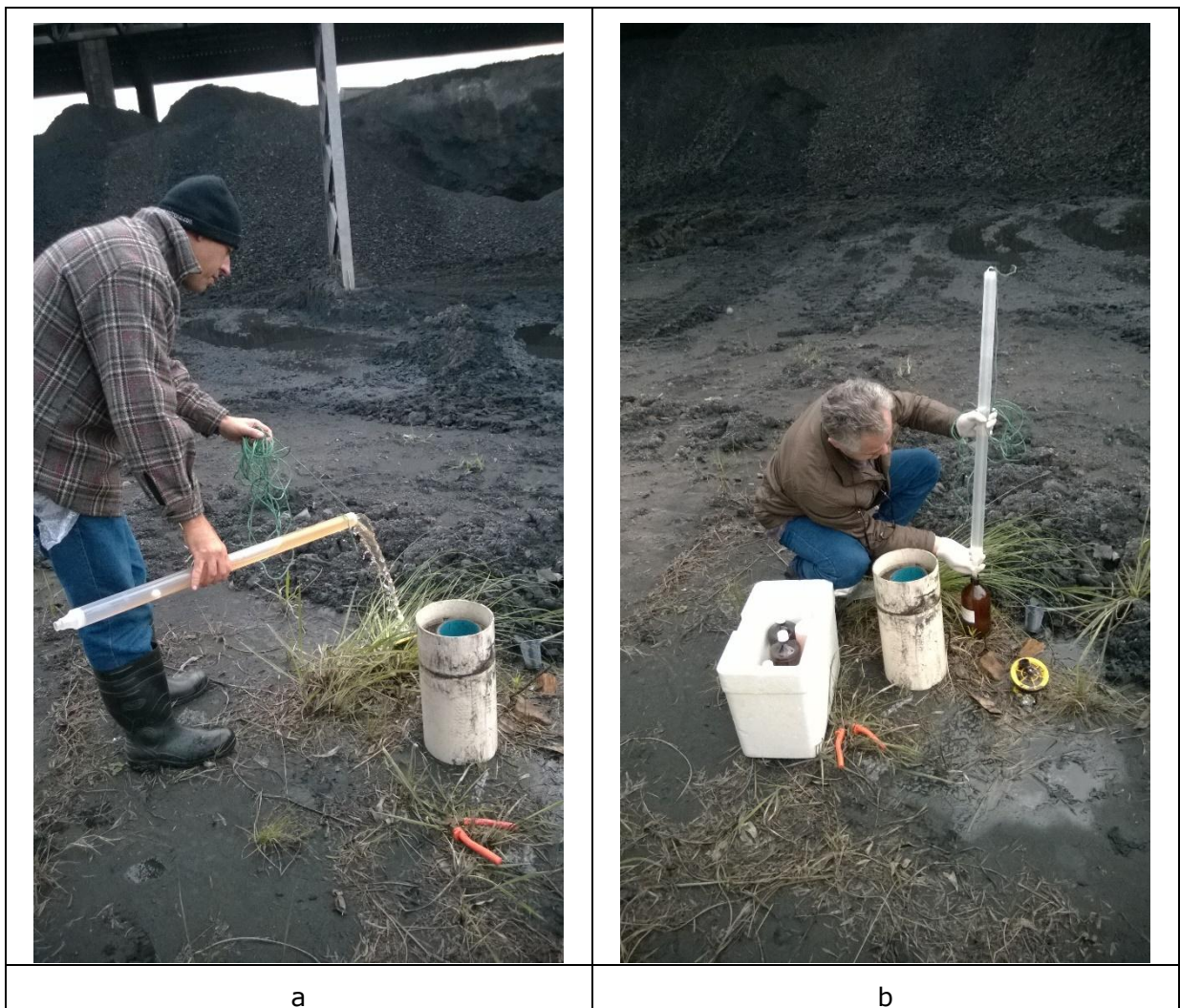
Figura 8. Esgotamento e coleta do poço PM-09, realizados nos dias 02 3 03 de junho de 2015 com amostrador descartável tipo bailer . Note-se a significativa turbidez da água do poço.
