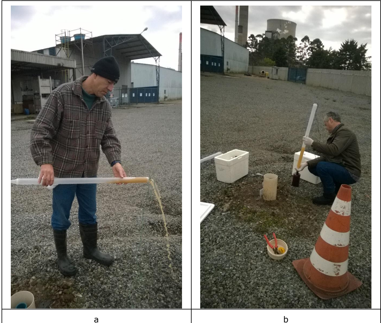
Figura 9. Esgotamento e coleta do poço PM-13, realizados nos dias 02 3 03 de junho de 2015 com amostrador descartável tipo bailer . Note-se a significativa turbidez da água do poço.
