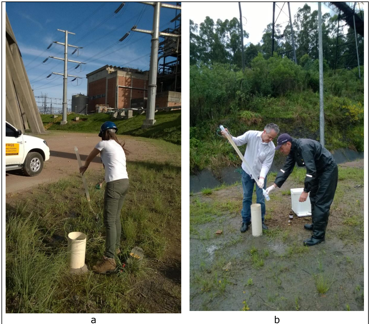
Figura 8. Esgotamento do poço PM-3 (a) e coleta no poço PM-12 (b), realizados na segunda campanha amostral, nos dias 15 e 16 de outubro de 2014, com amostrador descartável tipo beiler .
