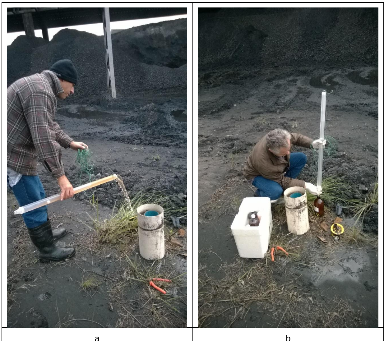
Figura 13. Esgotamento e coleta do poço PM-09, realizados na quarta campanha amostral, nos dias 02 e 03 de junho de 2015, com amostrador descartável tipo bailer . Note-se a significativa turbidez da água do poço.
