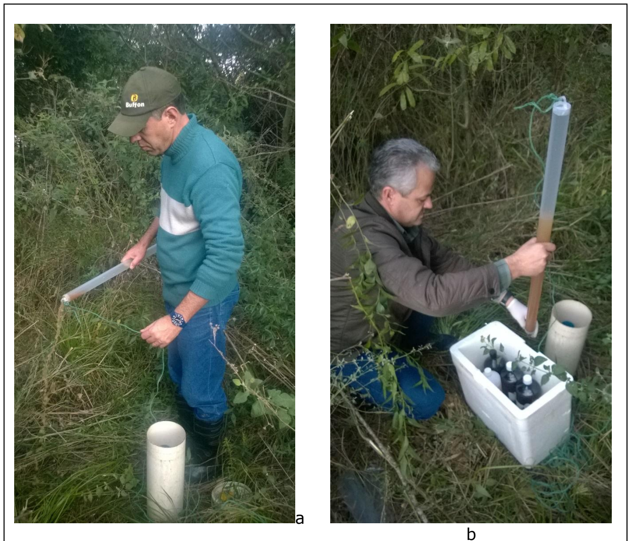
Figura 5. Esgotamento e coleta do poço PM-17, realizados nos dias 02 3 03 de junho de 2015 com amostrador descartável tipo bailer . Note-se a forte turbidez na água do poço.
